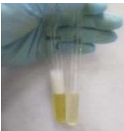
Figura 4. Prueba de saponinas en extracto etanólico y acuoso.
