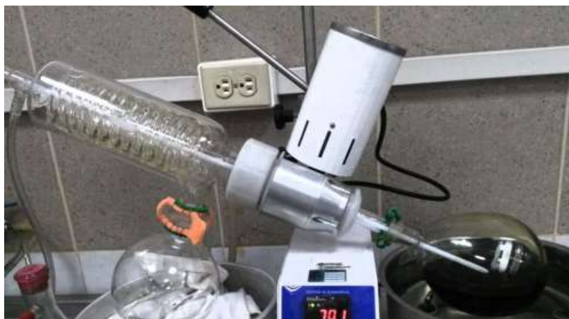
Figura 3. Extracto etanólico en el rotavapor.
