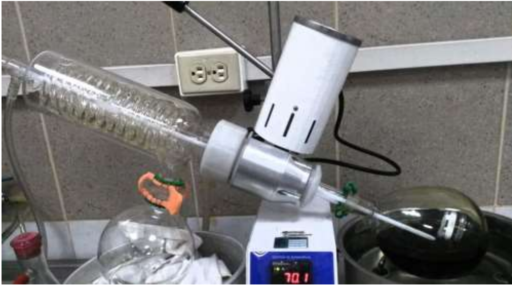
Figura 11. Extracto etanólico en rotavapor
