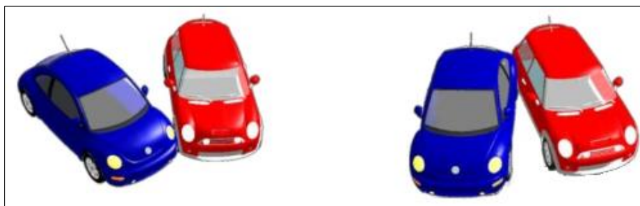
Figura 16. Choque lateral angular Fuente: (Cesvi Colombia, 2014)
