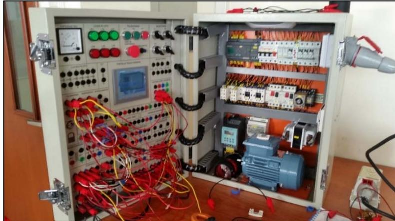
Figura 147. Cableado del circuito de fuerza y control practica #8.
