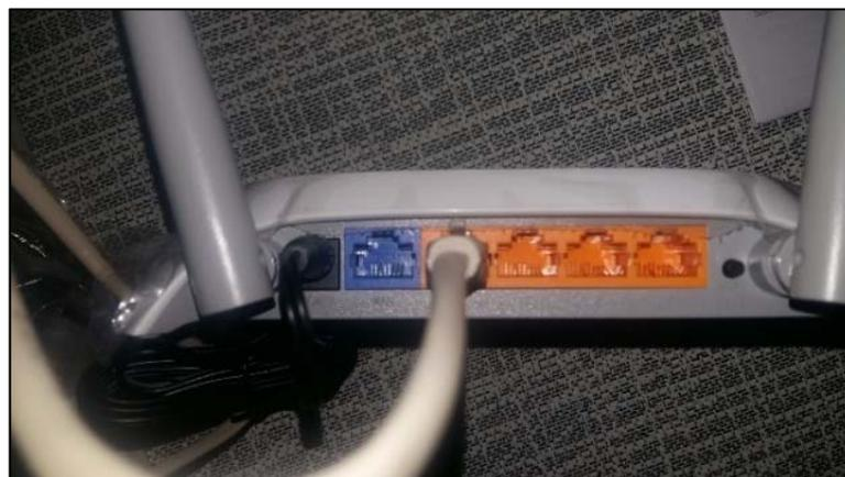
Figura 48. Conexión del cable RJ45 en el puerto P1.
