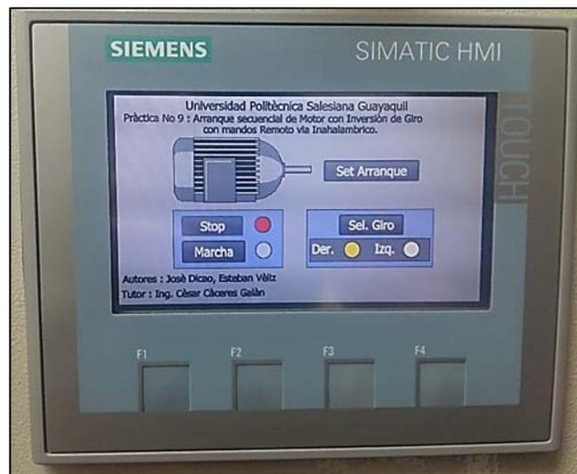
Figura 8. Pantalla táctil HMI KTP 400.
