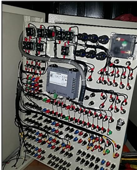
Figura 43. Cableado de tablero de conectores rápidos.
