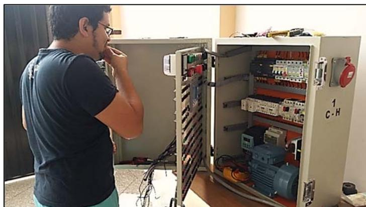
Figura 42. Cableado de elementos de Control y Fuerza.
