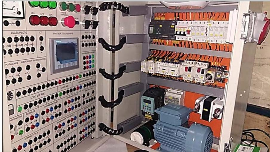
Figura 142. Conexión eléctrica de módulo a red trifásica 220 Vac.
