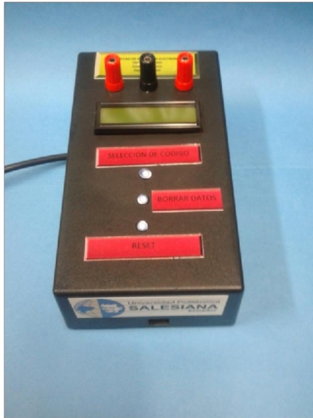
Figura 3.120: Módulo Decodificador Terminado
