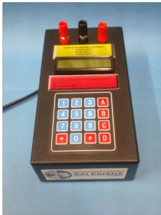
Figura 3 114: Módulo Codificador Terminado.
