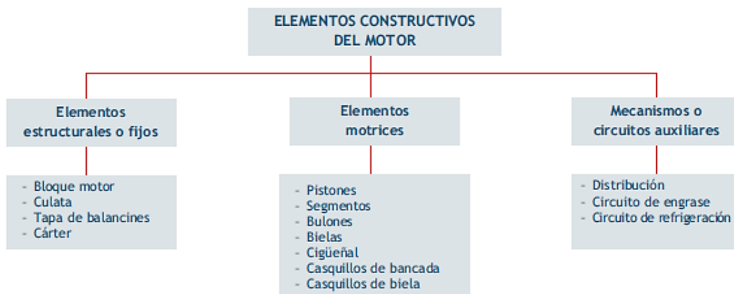
Figura 1. 1 Elementos constructivos del motor.
