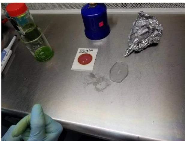
*Ilustración 37* Solidificación de las placas Petrifilm
