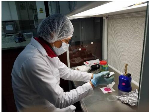
**Ilustración 35** Siembra de las muestras en las placas Petrifilm
