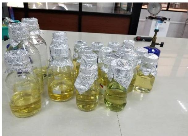
**Ilustración 31** Muestras de 200 ml listas para llevar al autoclave
