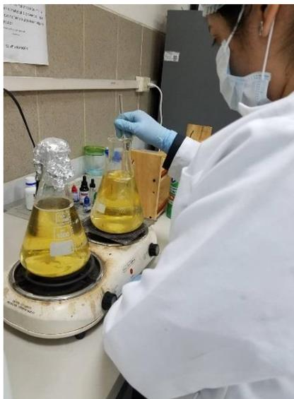
**Ilustración 30** Disolución de la Peptona a través de calor
