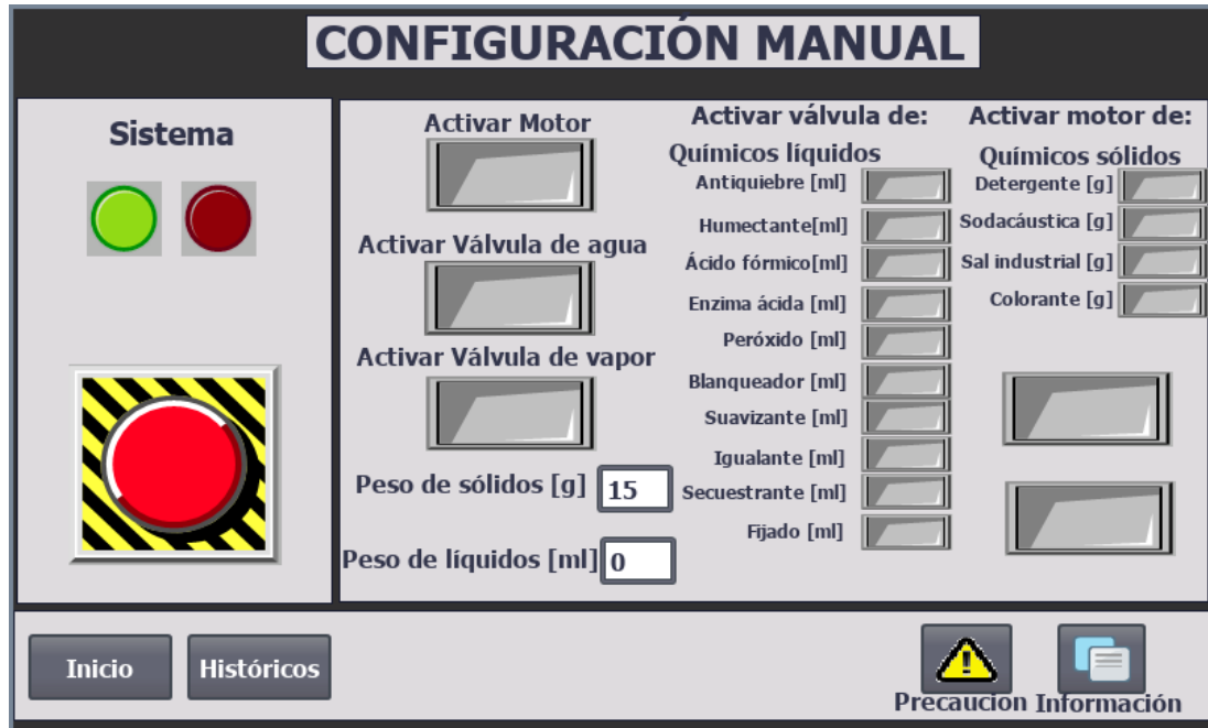
Pantalla de configuración manual del HMI del proceso de lavado, Elaborado por: Erika Fernanda Guallichico Molina
