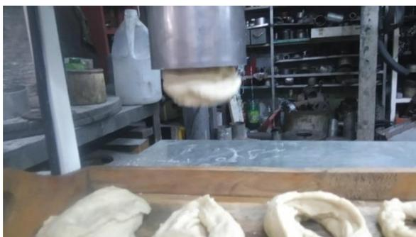
Figura 70. Inyección del donut realizado por el prototipo [51].
