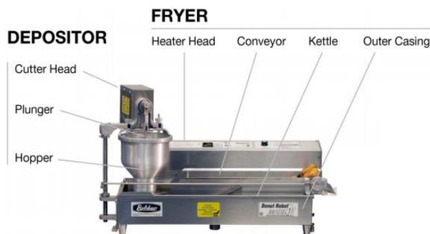
Figura 6. Máquina Semiautomática para fabricación de donuts [12].
