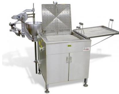
Figura 22. Máquina con manivela para fabricación de donuts [43].
