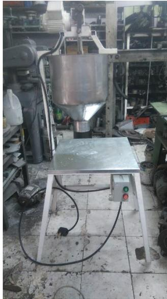
Figura 65. Prototipo para inyección de masa de donuts [51].
