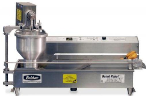
Figura 21. Máquina semiautomática para fabricación de donuts [31].
