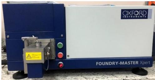
**Figura 82.** Máquina FOUNDRY-MASTER Xpert para ensayo espectrofotométrico.
