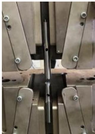
**Figura 95.** Ruptura de la probeta al finalizar el ensayo.
