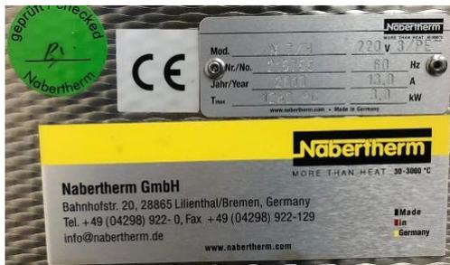
**Figura 75.** Placa de especificaciones de horno de temple.
