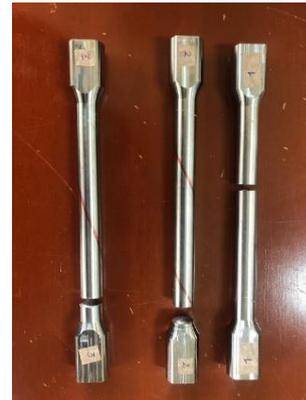
**Figura 101.** Ruptura de probeta en estado de suministro.
