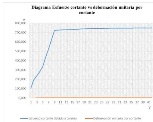
Figura 41. Diagrama de esfuerzo cortante vs deformación unitaria por cortante en probeta 1.
