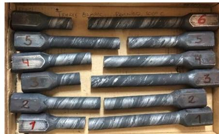
**Figura 102.** Probetas con temple de 830°C y revenido de 500°C después de ser sometidas al ensayo de tracción.
