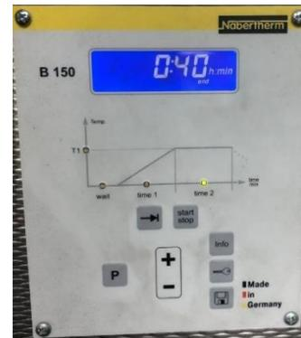
**Figura 76.** Configuración del tiempo para temple.
