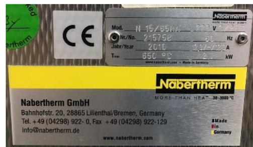
**Figura 79.** Placa de especificaciones de horno de revenido.
