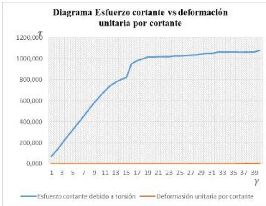
Figura 61. Diagrama de esfuerzo cortante vs deformación unitaria por cortante en probeta 2.
