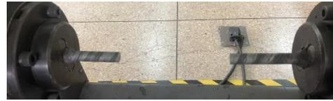
**Figura 100.** Ruptura de probeta con tratamiento térmico al llegar al límite.
