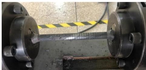
**Figura 99.** Probetas con tratamiento térmico muestran la ductilidad que adquirió con el tratamiento térmico previo a la ruptura.
