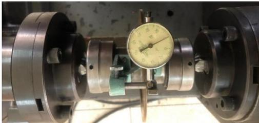
**Figura 98.** Uso del medidor del ángulo de torsión.
