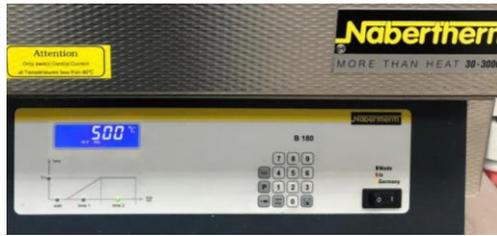
**Figura 80.** Configuración de temperatura para realizar el revenido.
