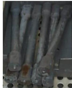
**Figura 77.** Estado de probetas al salir del temple.
