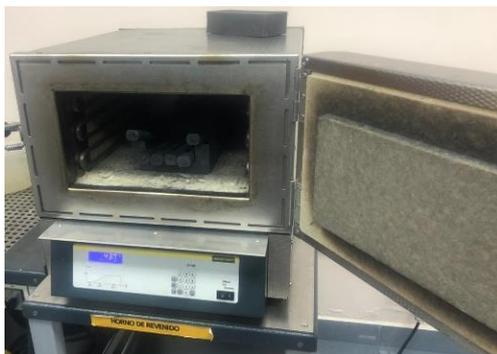
**Figura 78.** Horno NABERTHERM N 15/65HA para tratamiento de temple.
