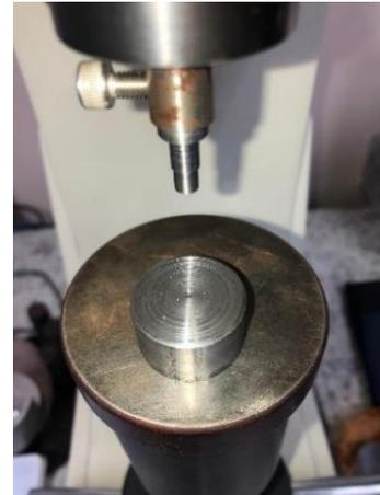
**Figura 88.** Inicio de ensayo de dureza en
