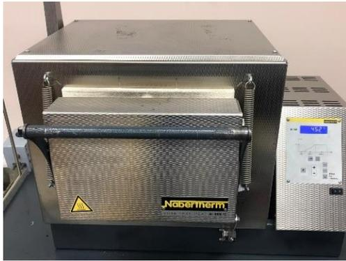
**Figura 74.** Horno NABERTHERM N7/H de temple aumentando la temperatura.
