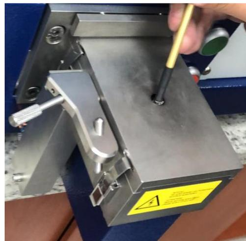
**Figura 85.** Limpieza del lente después de cada toma de datos.
