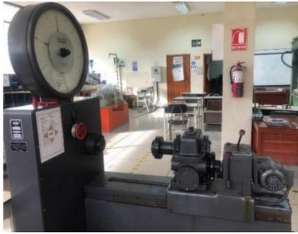
**Figura 96.** Máquina AVERY para ensayo de torsión.
