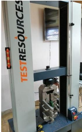
**Figura 91.** Máquina TEST RESOURCES para ensayo de tracción.
