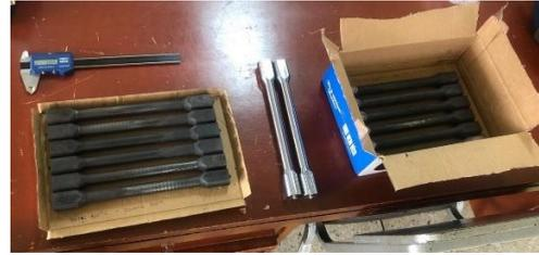
**Figura 90.** Probetas que se sometieron a ensayo de dureza.
