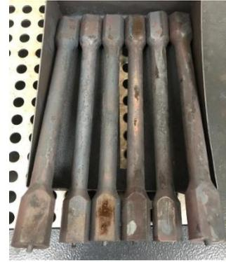
**Figura 81.** Estado de probetas al salir del revenido.
