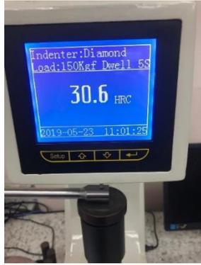
**Figura 89.** Muestra de resultado obtenido en máquina al realizar ensayo en probetas.
