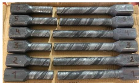
**Figura 103.** Probetas con temple de 860°C y revenido de 500°C después de ser sometidas al ensayo de tracción.
