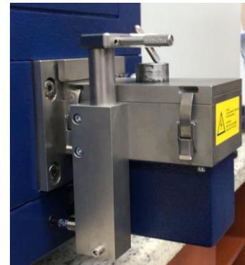
**Figura 84.** Probeta sujeta para ensayo.
