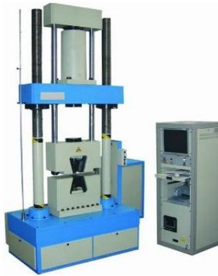
**Figura 26.** Máquina universal de ensayos de tracción [17].
