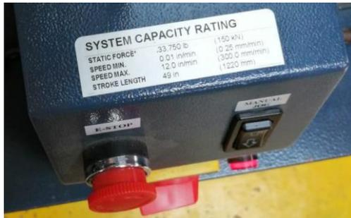
**Figura 92.** Placa técnica de la capacidad de la máquina.
