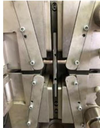
**Figura 93.** Probeta sujeta a máquina de tracción.
