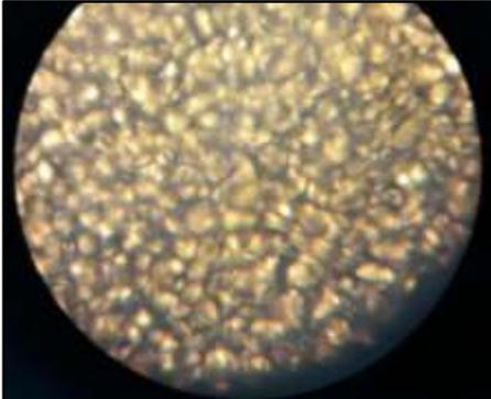
Figura 23. Forma de almidón del método seco.
