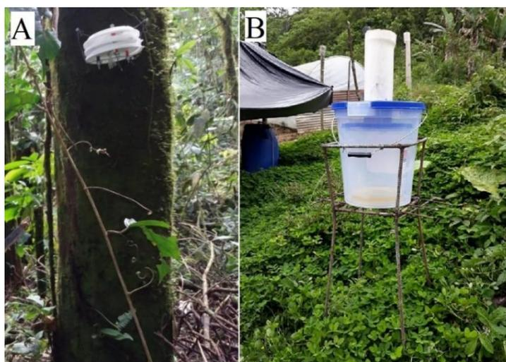
*Figura 22.* Monitoreo de variables climáticas en el área de investigación A) ubicación del sensor en el transecto Cueva Garganta del Dino y B) colector de agua lluvia con aceite de parafina.
