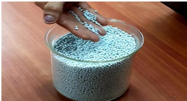
**Figura 11.** Pellets o esferas, resultado del PET [38].
