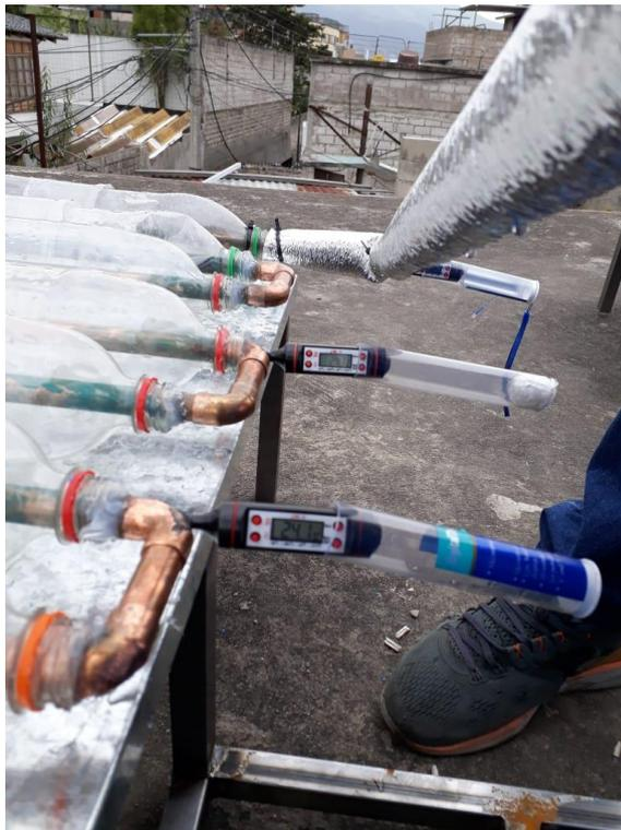
Instalación de instrumentos de medida en la tubería de cobre tipo M.
