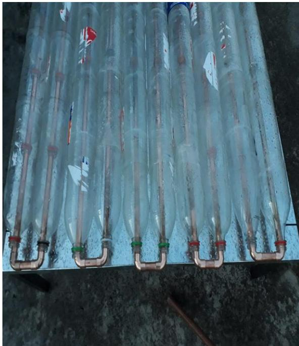
Tubería de cobre tipo M montada en la estructura metálica.
