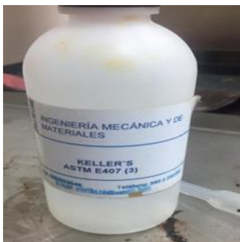
Figura 39. Ácido utilizado en análisis metalográfico según norma ASTM E407.
