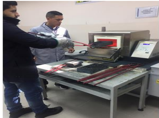
Anexo 10. Enfriamiento en arena sílica. Elaborado por Gary Morillo y Luis Calderón.
