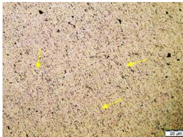
Figura 38. Revenido 6h, matriz de aluminio, presencia de precipitados en forma de dendritas y microrechupes
