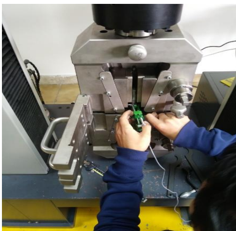
Anexo 14. Colocación de string gauge en las probetas. Elaborado por Gary Morillo y Luis Calderón.
