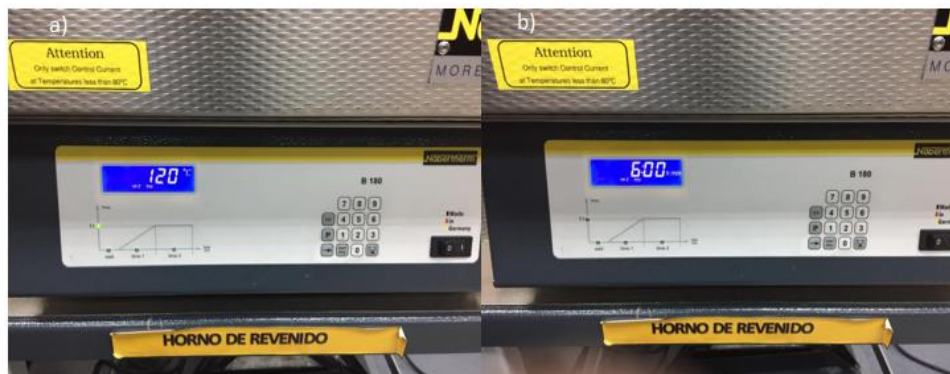
Figura 22. a) Temperatura de revenido. b) Tiempos de residencia de segundo grupo de probetas para revenido.
