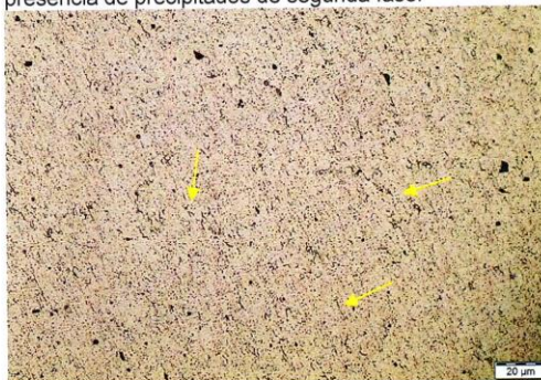
Fotografía N° 5. Revenido 6h, matriz de aluminio, presencia de precipitados en forma de dendritas y microrechupes.
