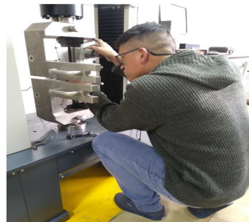
Anexo 14. Colocación de string gauge en las probetas. Elaborado por Gary Morillo y Luis Calderón.
