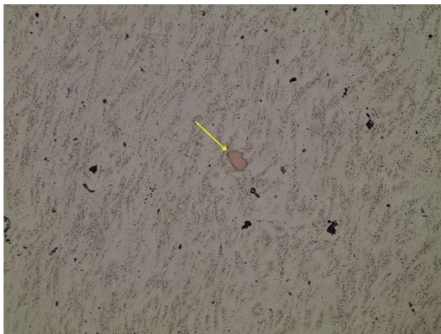
Figura 35. MB, matriz aluminio, detalle de los precipitados de segunda fase (puntos negros) e inclusiones de cobre (Cu).
