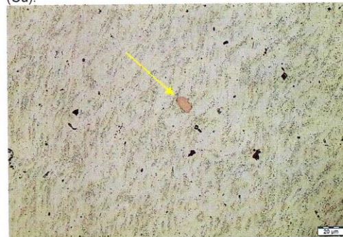
Fotografía N° 4. MB, matriz de aluminio, detalle de los precipitados de segunda fase (puntos negros) e inclusiones de cobre (Cu).
