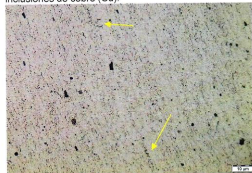
Fotografía N° 5. Revenido 6h, detalle de los precipitados en forma de dendritas y microrechupes.
