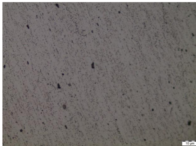
Figura 37. Revenido 6h, detalle de los precipitados en forma de dendritas y microrechupes. Revenido 6h, detalle de los precipitados en forma de dendritas y microrechupes.
