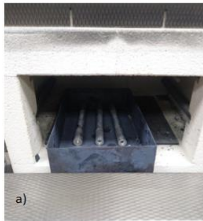
Figura 16. a) Enfriamiento de las probetas en el horno.
