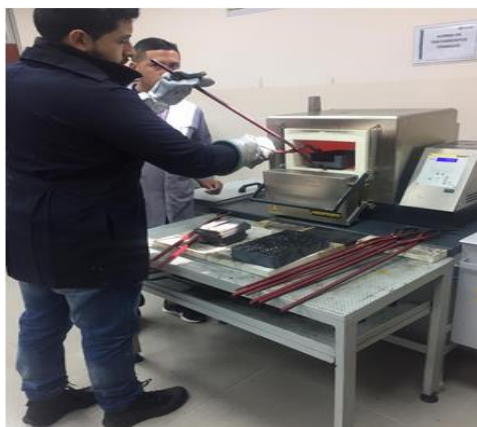
Anexo 11. Tratamiento térmico de revenido. Elaborado por Gary Morillo y Luis Calderón.
