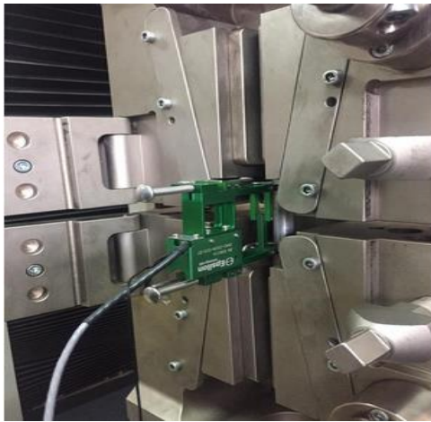
Anexo 16. Inicio de ensayo de tracción. Elaborado por Gary Morillo y Luis Calderón.
