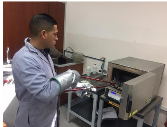
Anexo 11. Tratamiento térmico de revenido. Elaborado por Gary Morillo y Luis Calderón.
