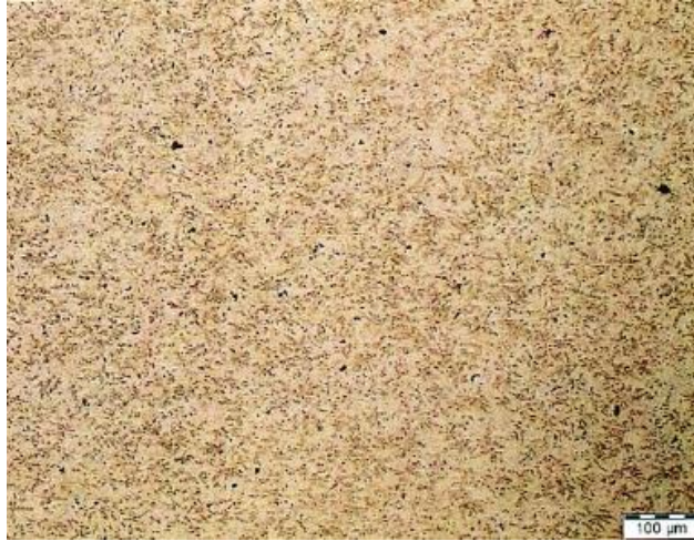
Figura 36. Revenido 6h, la microestructura no homogénea, que corresponde a un aluminio con presencia de precipitaciones de segunda fase
