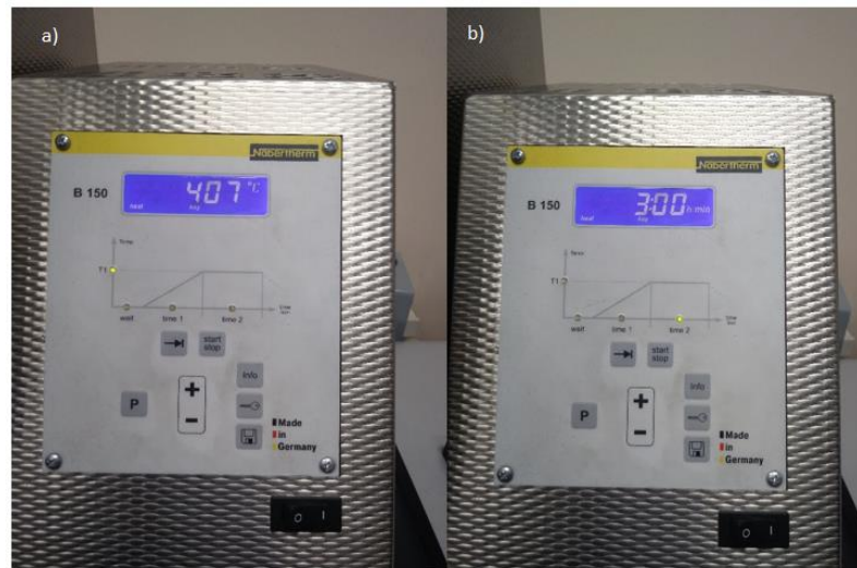
Figura 14. a) Temperatura [centígrados] programada en el horno de recocido, b) Tiempo [horas] de residencia de las probetas en el horno.
