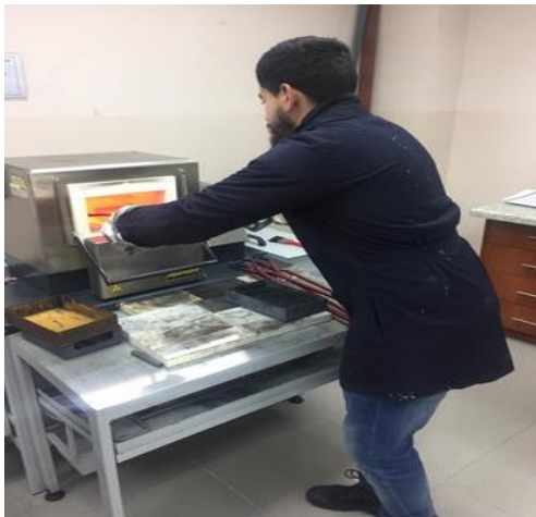
Anexo 11. Tratamiento térmico de revenido. Elaborado por Gary Morillo y Luis Calderón.
