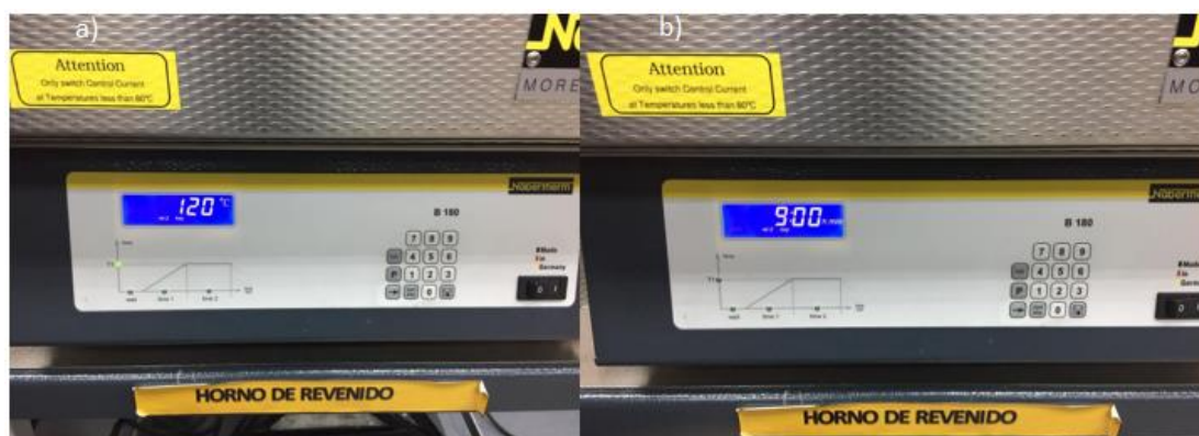
Figura 24. a) Temperatura de revenido. b) Tiempos de residencia de tercer grupo de probetas para revenido.
