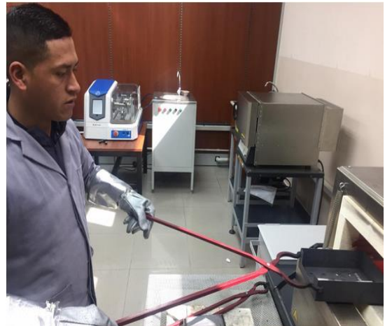
Anexo 11. Tratamiento térmico de revenido. Elaborado por Gary Morillo y Luis Calderón.
