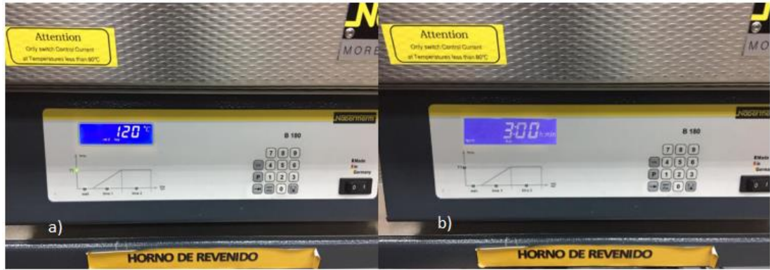
Figura 20. a) Temperatura para revenido. b) Tiempo de residencia de primer grupo de las probetas para revenido.
