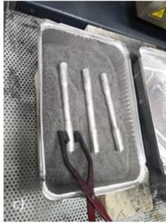
Figura 18. c) Enfriamiento de las probetas en arena sílica.
