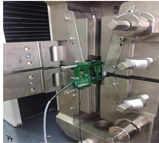
Anexo 16. Inicio de ensayo de tracción. Elaborado por Gary Morillo y Luis Calderón.
