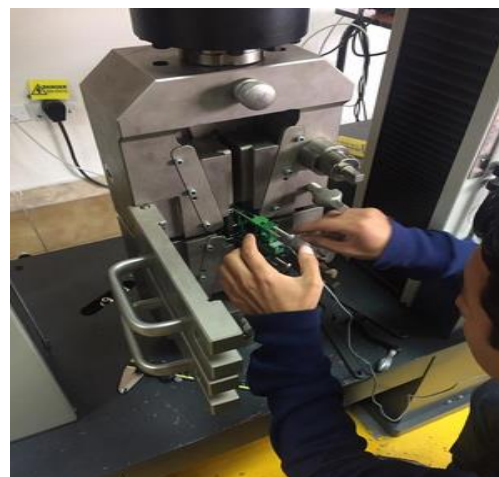
Anexo 14. Colocación de string gauge en las probetas. Elaborado por Gary Morillo y Luis Calderón.
