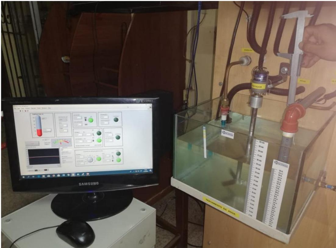
Figura 4.4: Verificación del Nivel de agua con un Vernier en comparación con el el Valor del Scada
