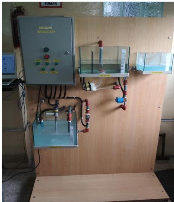
Figura 3.1: Maqueta del Sistema de control de PH de agua tratada
