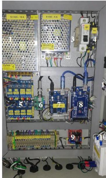
Figura 3.3: Parte interior del tablero eléctrico de control y fuerza
