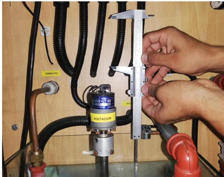
Figura 4.3: Medición de Nivel de agua con un Vernier en comparación con el ultrasónico
