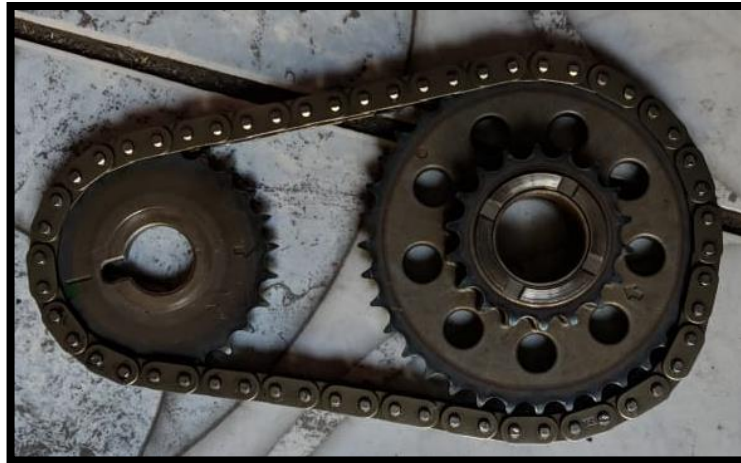
FIGURA 20: TRANSMISION COMPUESTA POR ENGRANAJES Y CADENA
