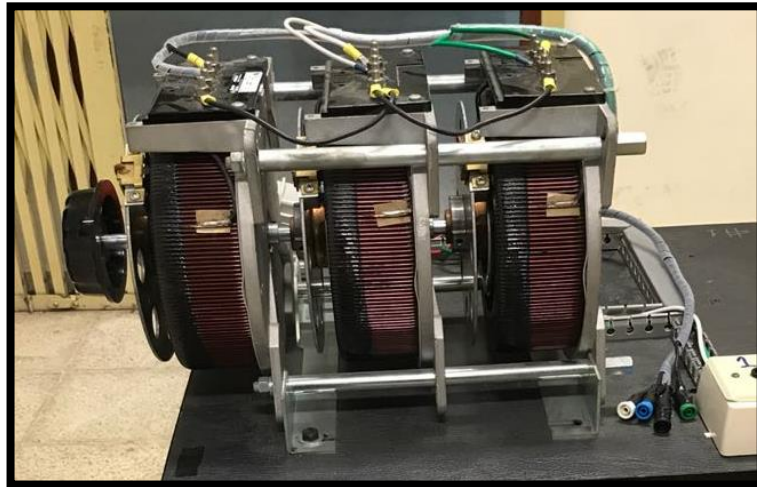
FIGURA 7: VISTA LATERAL DEL AUTOTRANSFORMADOR VARIABLE POWERSTAT.
