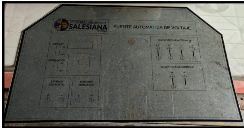
FIGURA 27: PANEL FRONTAL CON VINIL TEMPORAL PARA HACER LOS HUECOS.
