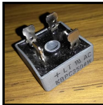
FIGURA 23: PUENTE RECTIFICADOR KBPC3504W
