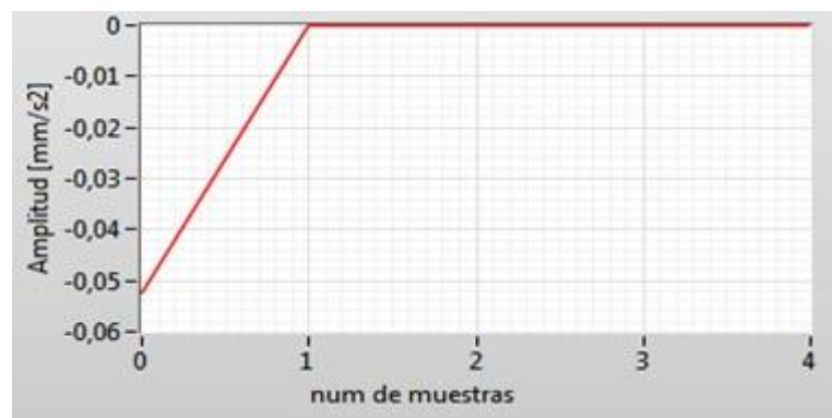
Figura 3.20 Respuesta al impulso para un filtro sin media simétrica en mm/s^2
