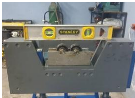
Figura 4.2 Nivelación de las bases flotantes.
