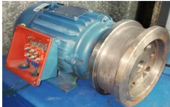
Motor eléctrico montado en la base adecuada sobre la maquina balanceadora (Cárdenas Frank , 2019)
