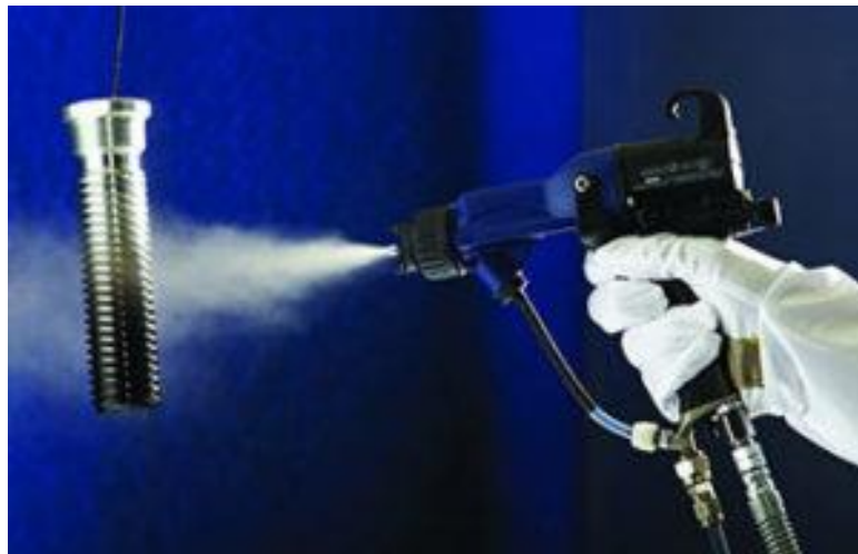
Figura 6 Aplicación de pintura electrostática [2].
