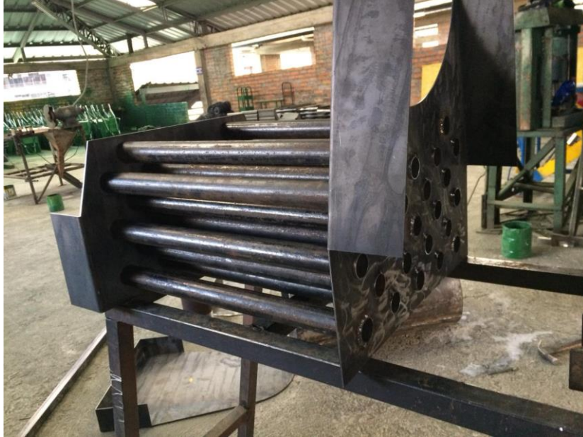
Figura 100 Intercambiador de Calor.
