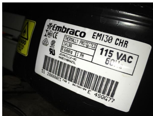
Anexo c. Compresor Embraco EM130 CHR. Elaborado por: Erick Chávez & Paúl Pachacama
