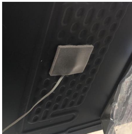
Anexo i. Termocupla del colector. Elaborado por: Erick Chávez & Paúl Pachacama
