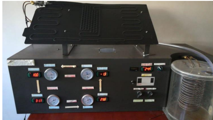
Anexo a. Bomba de calor DX-SAHP. Elaborado por: Erick Chávez & Paúl Pachacama
