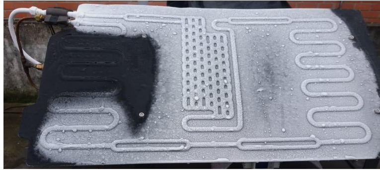
Anexo d. Colector evaporador. Elaborado por: Erick Chávez & Paúl Pachacama
