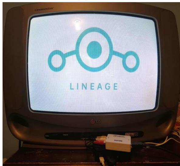
**Figura 23:** Pruebas al conversor HDMI a video compuesto RCA
