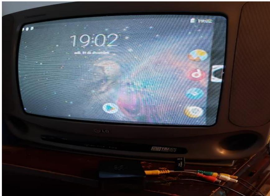
**Figura 21:** Calidad de imagen con el cable Jack 3.5 a RCA.
