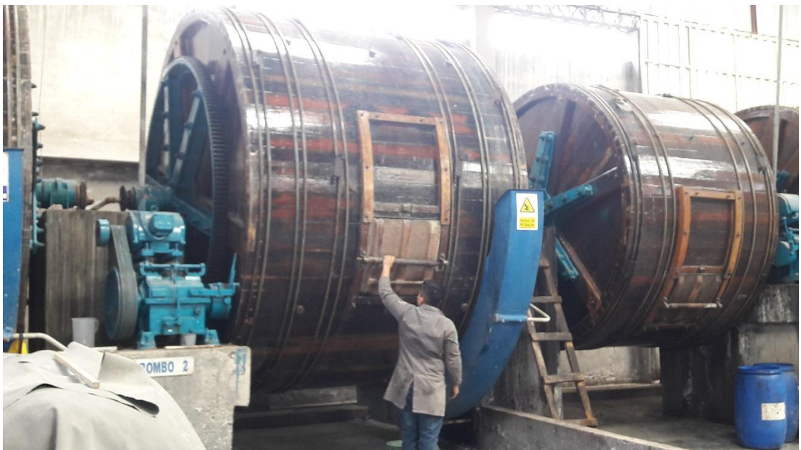
Ilustración 3. Equipos del proceso de curtido
