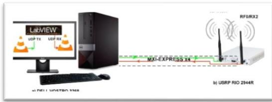
Figura 2. Diagrama de interfaces y equipos utilizados para la implementación.
