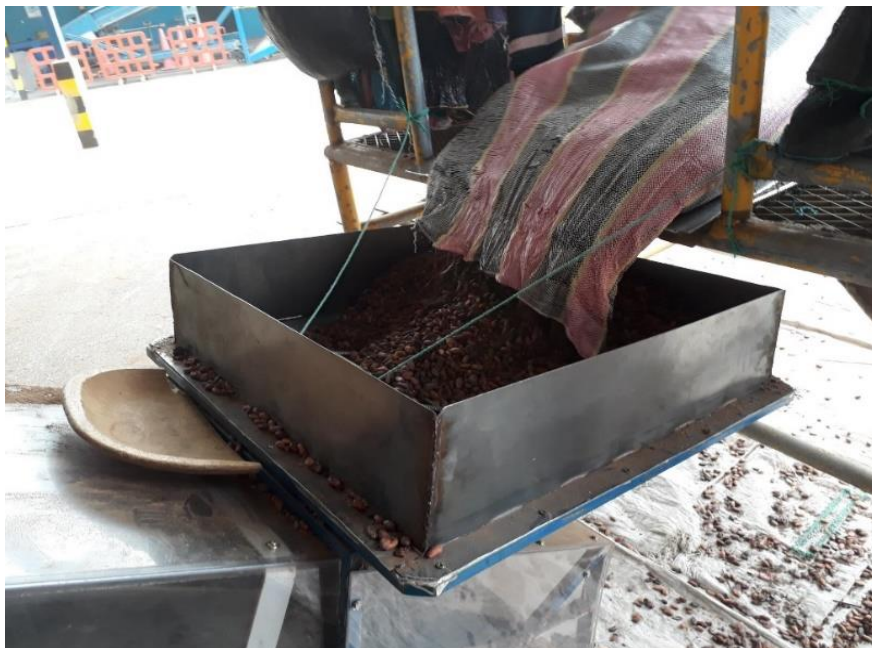
Figura 18: Nueva tolva de trabajo con paredes metálicas
