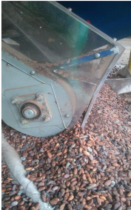
Figura 8: El cacao cae por debajo de la banda mediante una compuerta
