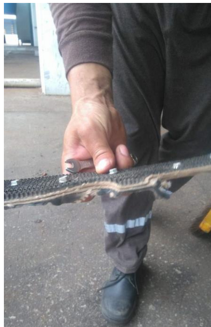
Figura 6: Lona que cubre la banda transportadora desgastada
