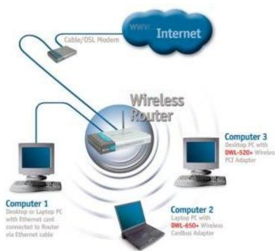
**Figura 2.34:** Sistema de comunicación wireless
