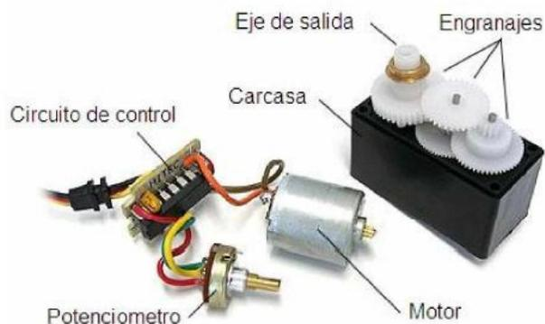
**Figura 2.28:** Esquema de la constitución de un servomotor
