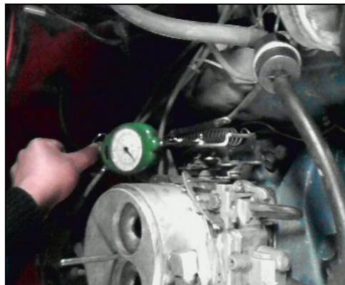
**Figura 2.51:** Medición de la fuerza en la mariposa de aceleración
