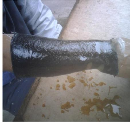
**Figura 3.7:** Colocación de la fibra.
