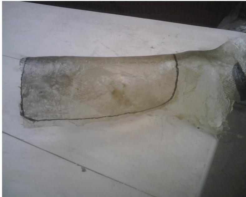
**Figura 3.8:** Marcado y corte del molde.
