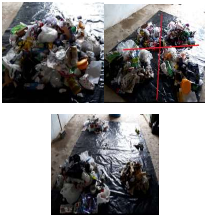
Ilustración 12. Recogida, homogenización y método de cuarteo de los residuos sólidos.
