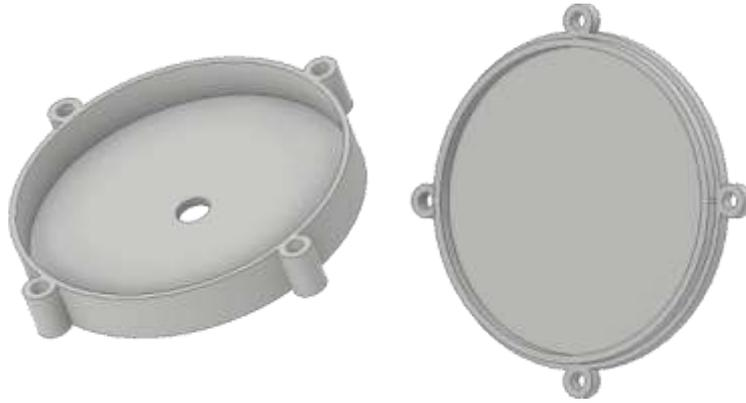
Imagen 16. Diseño de caja protectora para anillo LED RGB
