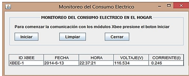
Figura 10. Valor obtenido del voltaje y la corriente consumida de la laptop en el sistema de monitoreo.
