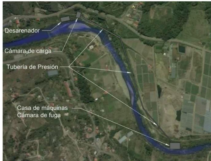
Figura 44 Esquema de captación de la central hidroeléctrica. Fuente: Autores
