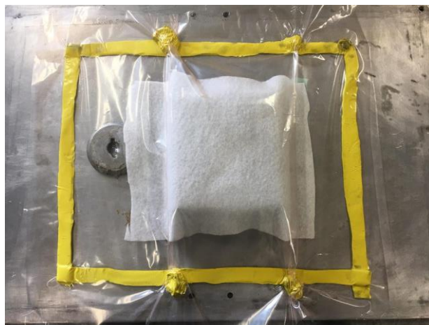
Figura 114 Sellado del conjunto Fuente: Autores
