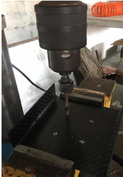
Figura 128 Taladrado de autoparte Fuente: Autores
