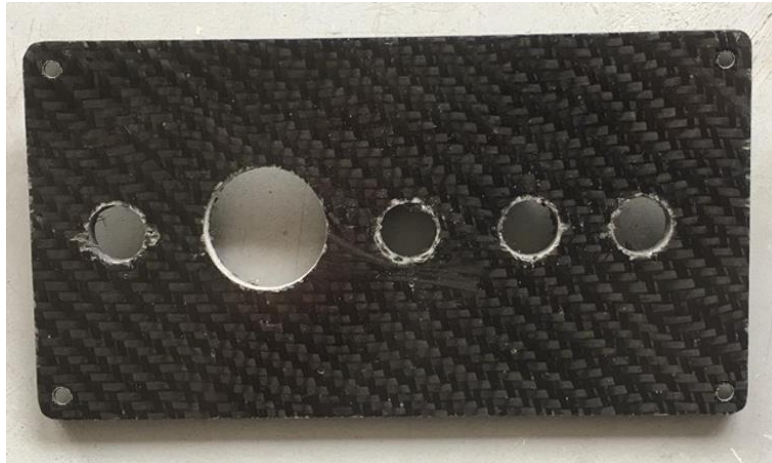
Figura 153 Tablero de encendido mecanizado Fuente: Autores
