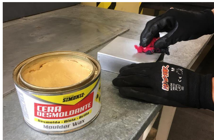
Figura 103 Aplicación de cera desmoldante sobre molde Fuente; Autores
