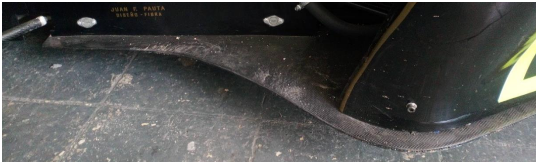
Figura 4 Fondo plano fabricado en fibra de carbono Fuente: Autores
