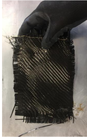
Figura 139 Colocación de la primera capa de fibra Fuente: Autores
