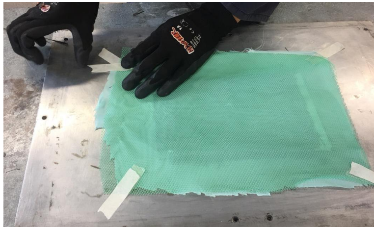
Figura 140 Colocación de peel ply y lámina de control de flujo para infusión Fuentes: Autores
