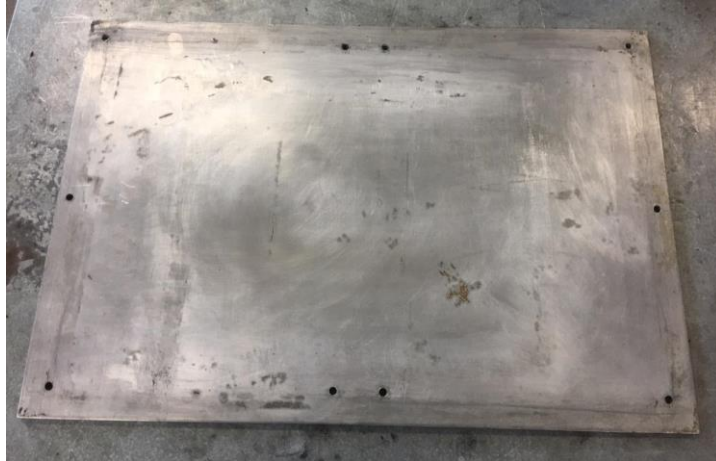
Figura 131 Placa de aluminio usada como molde Fuente: Autores
