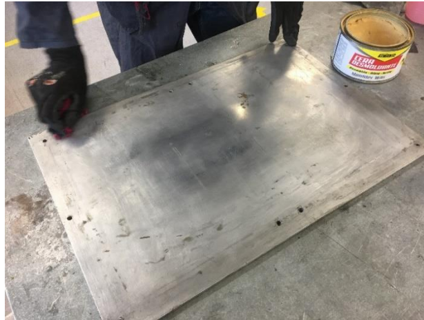
Figura 102 Aplicación de cera desmoldante sobre placa base de aluminio Fuente: Autores
