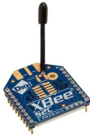
Figura 10. Módulo xbee s2c 2mw de antena wire [17]
