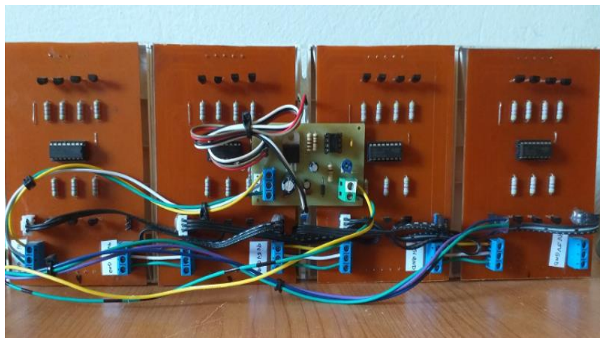
Figura 67. Conexión de módulos de pantalla Led.
