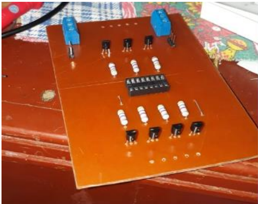
Figura 65. Montaje de componentes m3dulo de display de 7 segmentos.
