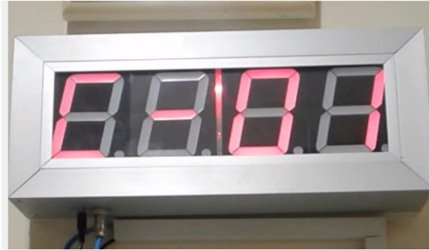
Figura 49. Pantalla LED mostrando número de cama del paciente que realizó un llamado a enfermería.
