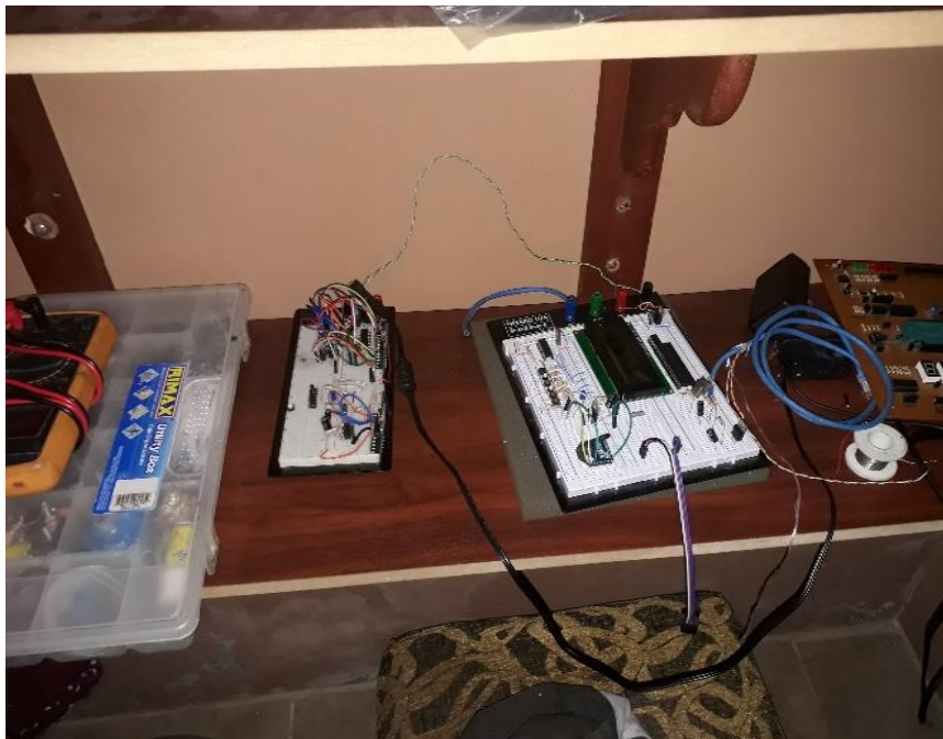
Figura 61. Primer diseño en protoboard de la tarjeta principal del sistema.
