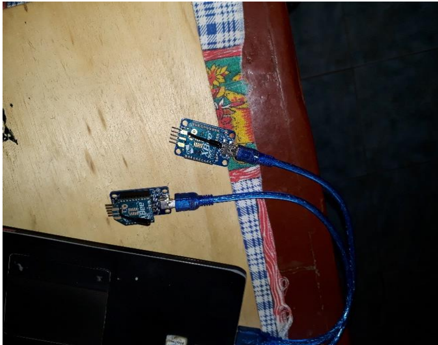
Figura 60. Equipos XBee conectados mediante XBee Usb Adapter.
