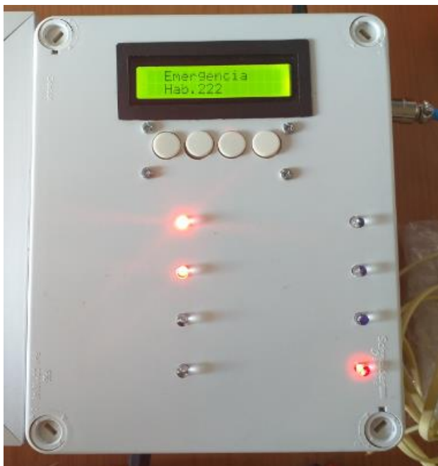
Figura 46. Unidad central procesando un llamado a enfermería.
