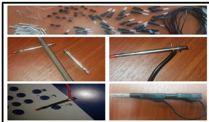
**Figura 90.** Construcción de los terminales de prueba.
