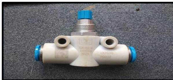
**Figura 25.** Válvula estranguladora.
