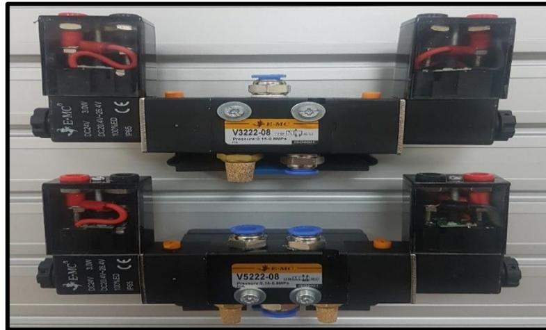
**Figura 87.** Conexión de las bobinas de las electroválvulas.
