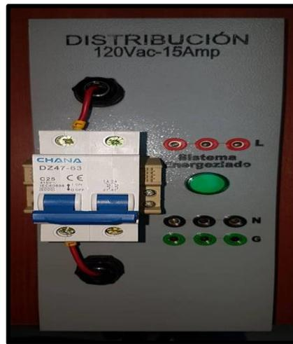
**Figura 62.** Lámina de distribución 120Vac-15Amp.
