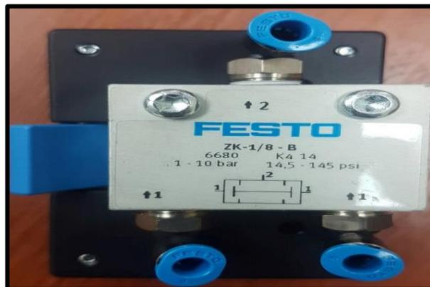
**Figura 23.** Válvula de simultaneidad Y.
