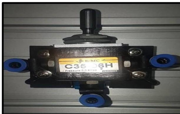
**Figura 81.** Implementación de racores y adaptador en válvula selectora.
