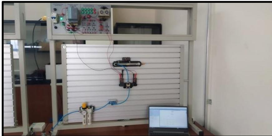
**Figura 135.** Montaje de accionamiento electroneumático para temporizador.
