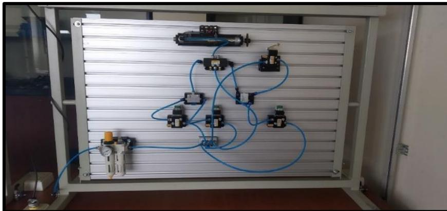
**Figura 149.** Montaje circuito neumático de secuencia lógica.
