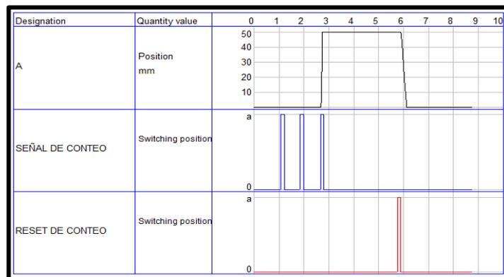
**Figura 109.** Diagrama de fase de contador neumático.
