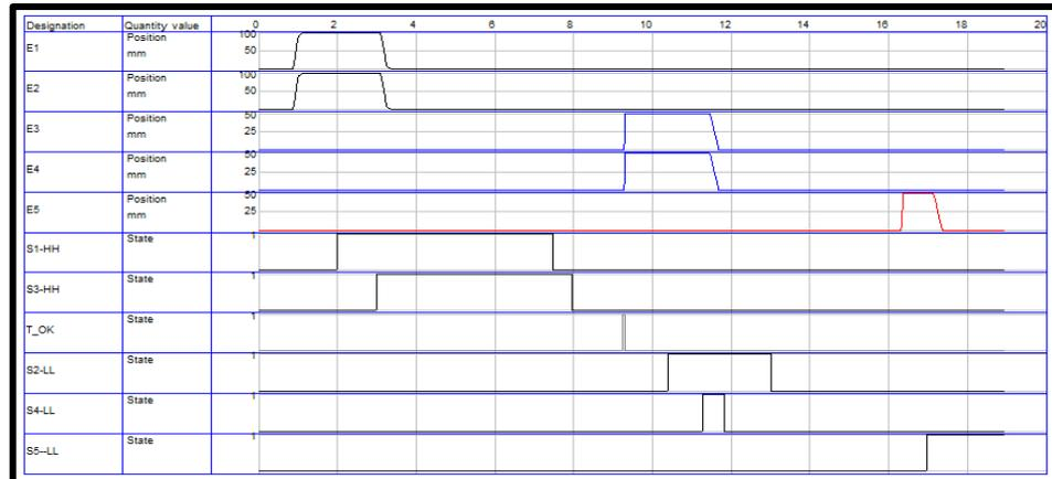
**Figura 207.** Diagrama de fase mezcladora de líquidos.
