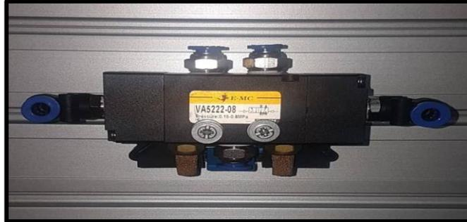
**Figura 82.** Implementación de racores en la válvula pilotaje neumático.
