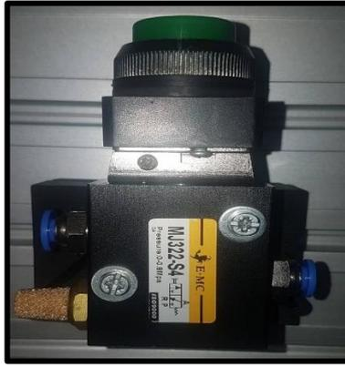
**Figura 79.** Montaje de racores y adaptador en válvula con pulsador.
