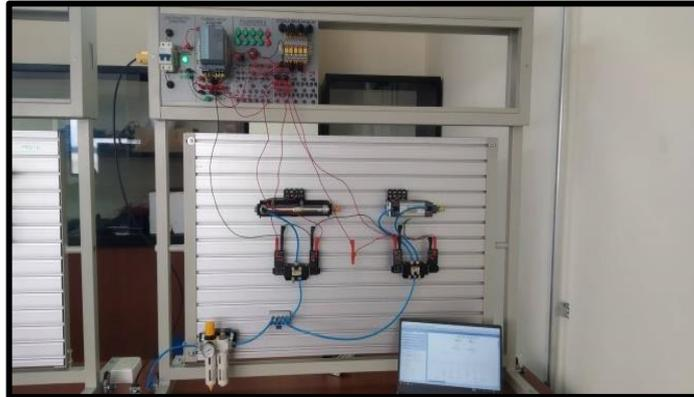
**Figura 133.** Montaje de accionamiento electroneumático básico.
