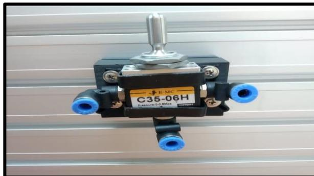
**Figura 18.** Válvula de selección con interruptor.
