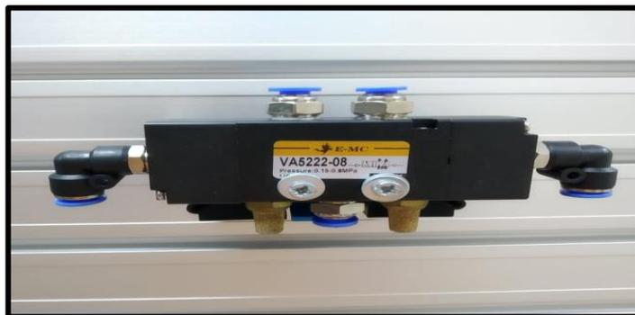
**Figura 20.** Válvula con pilotaje neumático.
