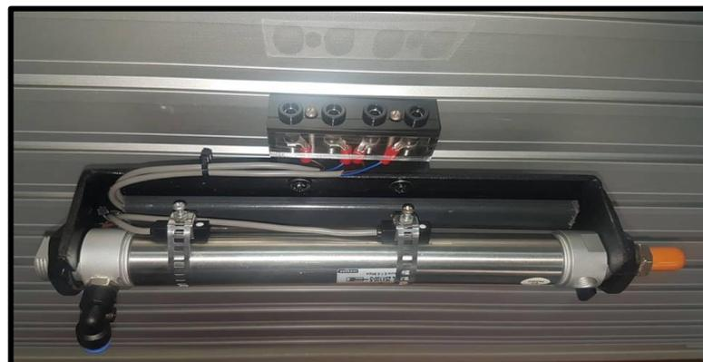
**Figura 88.** Montaje y conexiones en cilindro de simple efecto.
