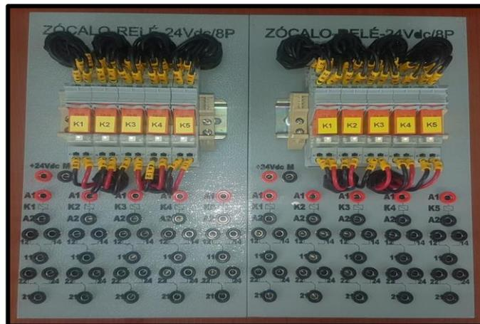
**Figura 66.** Lámina de Relés 24 Vdc.
