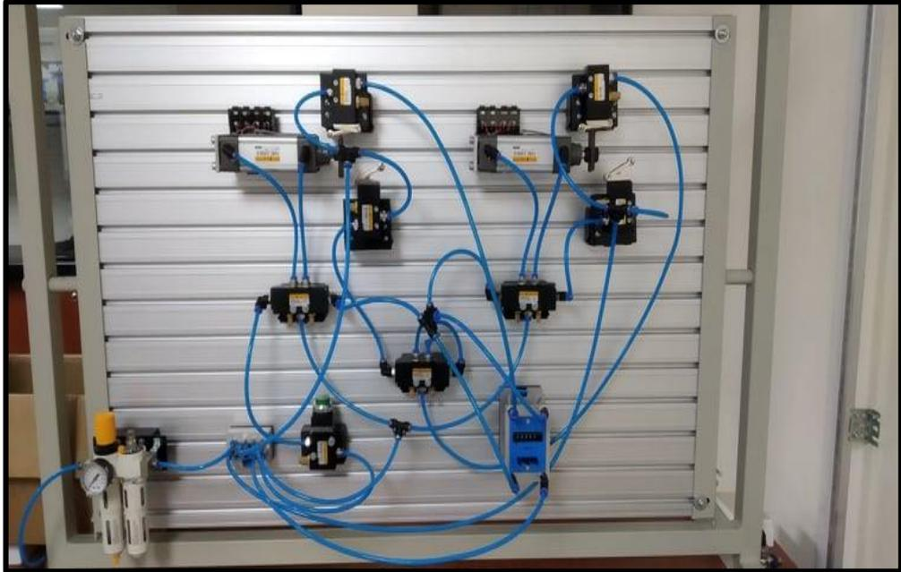
**Figura 172.** Montaje circuito neumático prueba de colchón.
