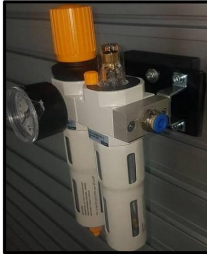
**Figura 77.** Unidad de mantenimiento EMC .
