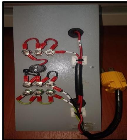
**Figura 63.** Conexiones en lámina de distribución.
