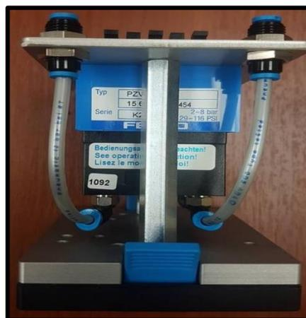
**Figura 35.** Contador neumático.
