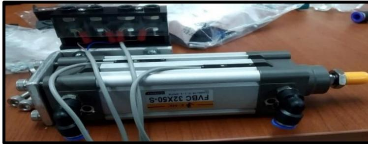
**Figura 89.** Montaje de base en cilindro de doble efecto.
