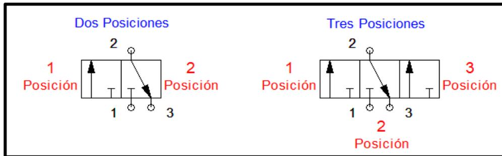
**Figura 8.** Representación de las posiciones de las válvulas.
