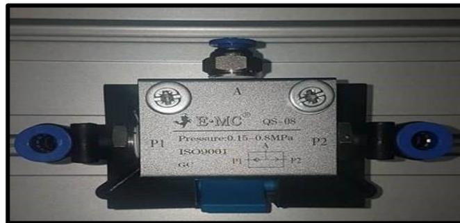
**Figura 83.** Implementación de racores y adaptadores en válvula O.
