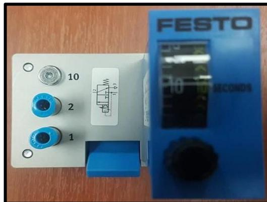
**Figura 33.** Temporizador neumático.
