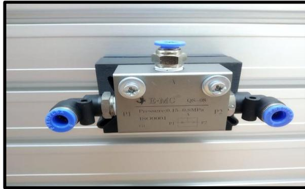
**Figura 22.** Válvula selectora.
