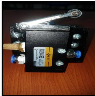
**Figura 80.** Montaje de adaptador en válvula con rodillo.
