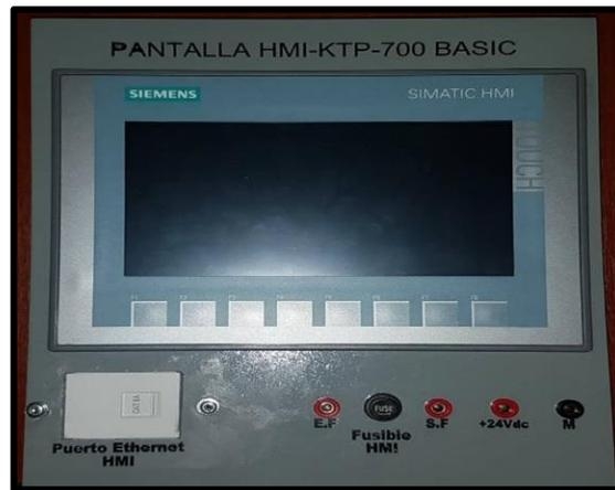
**Figura 68.** Lámina de la Pantalla HMI KTP700.
