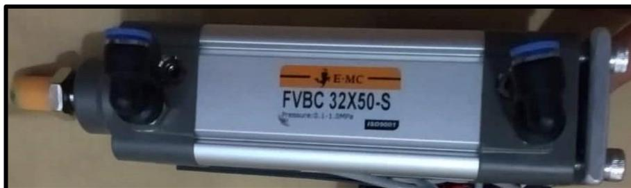
**Figura 7.** Cilindro doble efecto.
