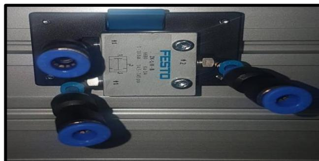
**Figura 84.** Implementación de racores reductores en válvula de simultaneidad.
