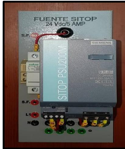
**Figura 64.** Lámina de fuente SITOP 24Vdc-2.5 A.
