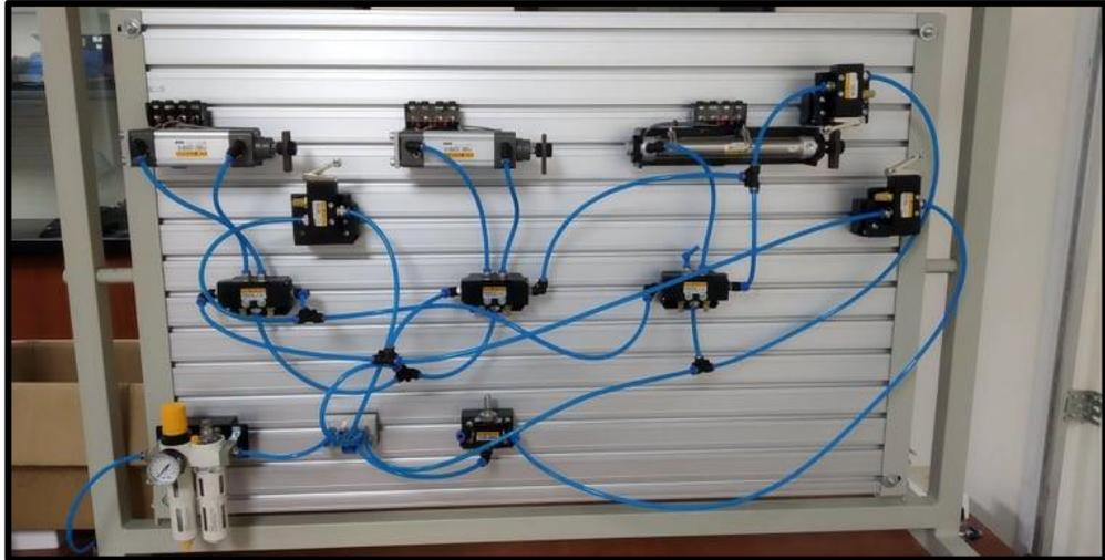
**Figura 159.** Montaje circuito neumático secuencia cíclica.
