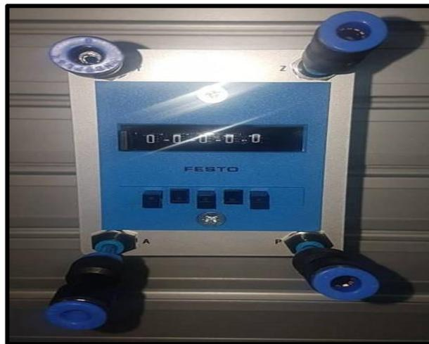
**Figura 86.** Implementación de racores reductores en contador neumático.
