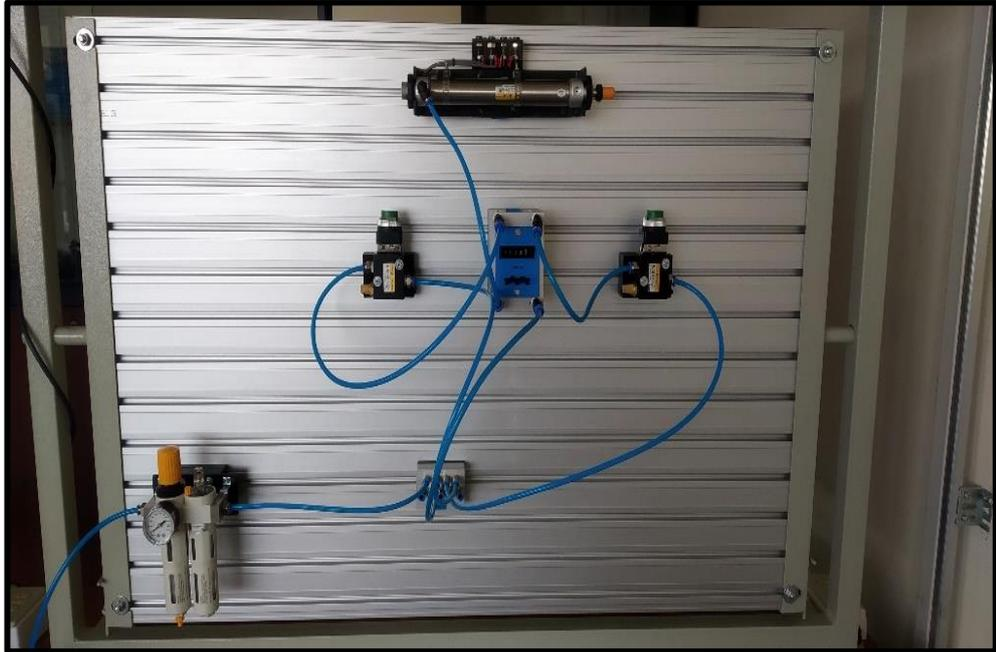
**Figura 115.** Conexiones de contador neumático.
