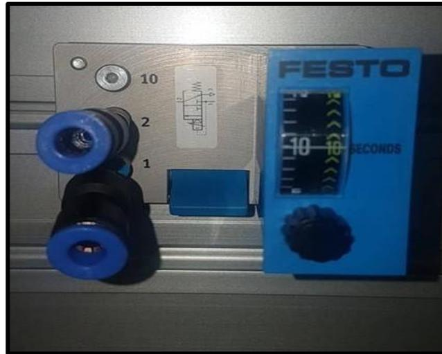
**Figura 85.** Implementación de racores reductores en temporizadores neumáticos.
