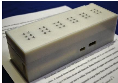
Figura 2. 2: Estructura del dispositivo de ayuda llamado Tactile.
