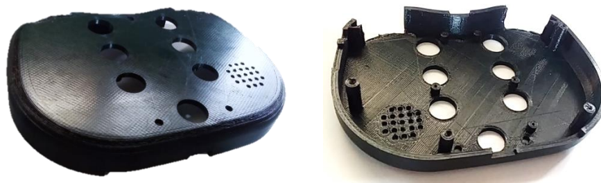
Figura 3. 22: Impresión final en tercera dimensión tapa superior.
