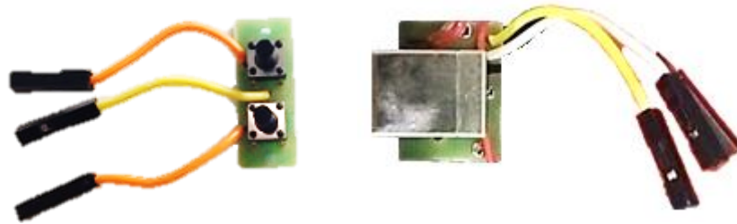
Figura 3. 14: Armado completo de la tarjeta electrónica de volumen y comunicación USB.
