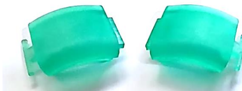
Figura 3. 23: Impresión final de botones tipo gatillo.
