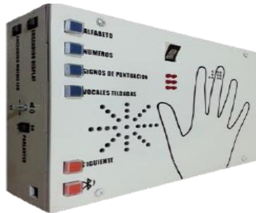
Figura 2. 4: Estructura del Prototipo electrónico de enseñanza del sistema Braille.
