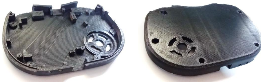
Figura 3. 21: Impresión final en tercera dimensión tapa inferior.
