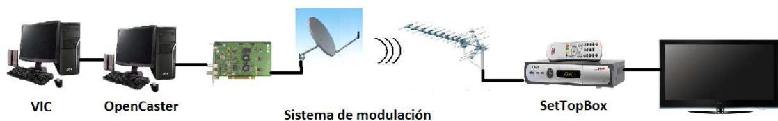
Figura 3.8. Esquema básico para la transmisión de un canal de televisión digital utilizando software libre
