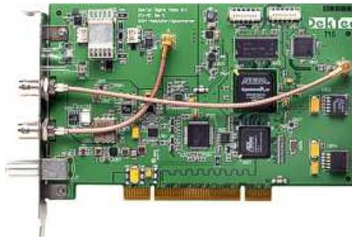
Figura 3.7. Tarjeta de modulación Dektec DTA-112 [23]
