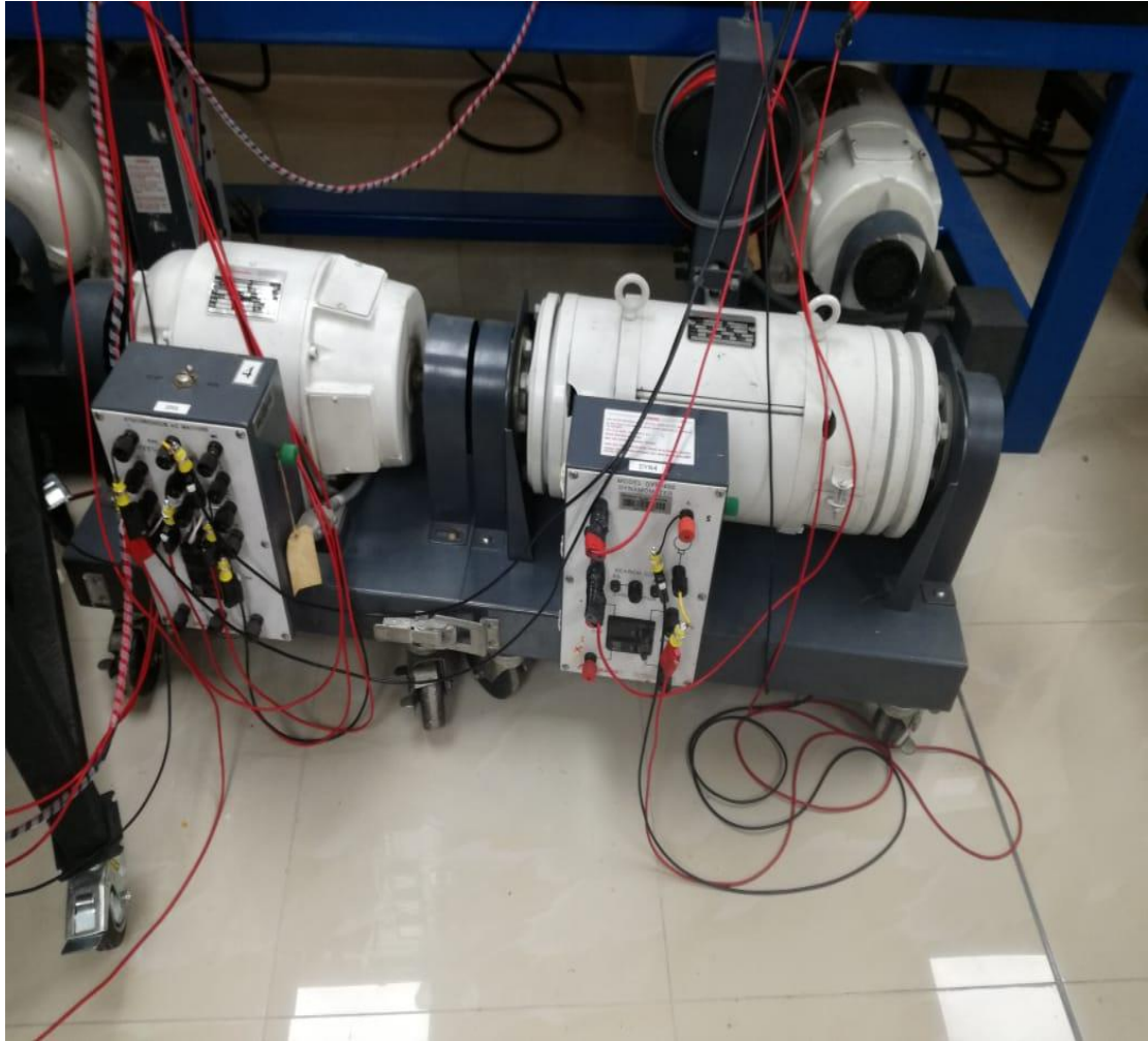
Anexo 3. Conexiones de dinamómetro DYN-400 y máquina sincrónica SM-300 acoplados lado A.
