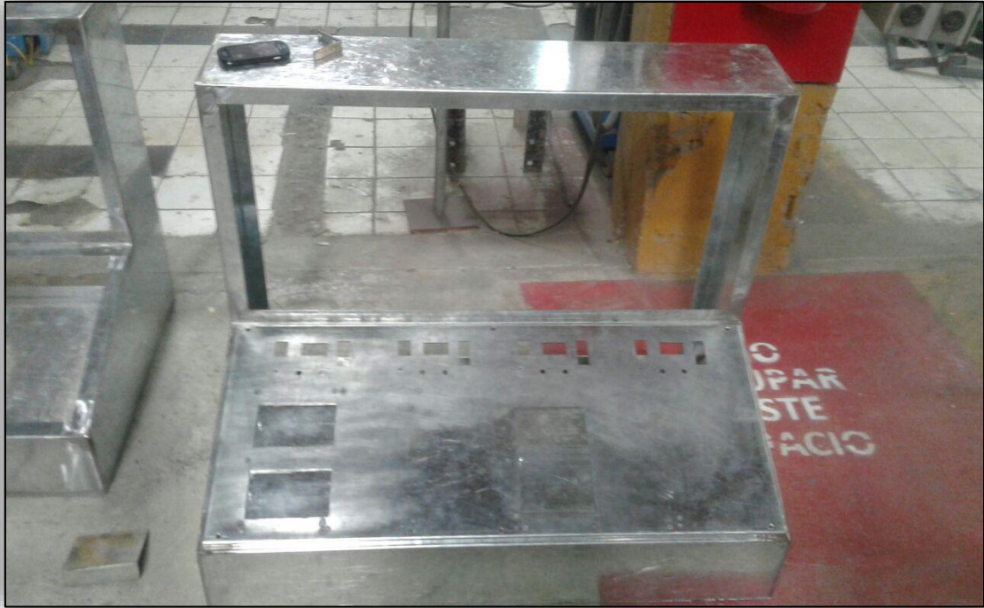
Figura 13. Calado de la estructura metálica.
