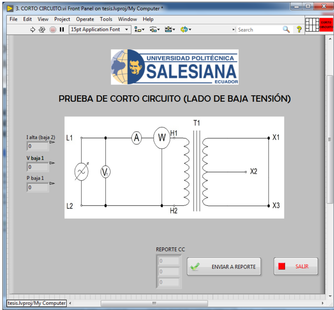
Figura 90. Interfaz prueba de corto circuito en baja tensión
