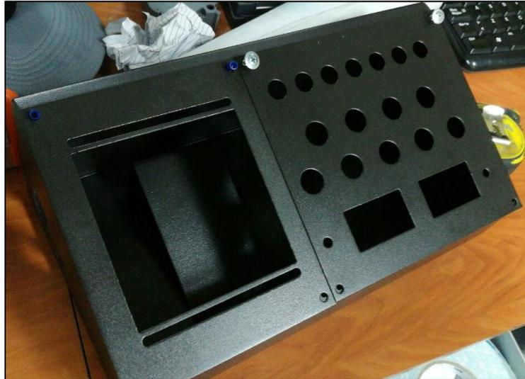
*Ilustración 17: Estructura del módulo terminada y pintada*
