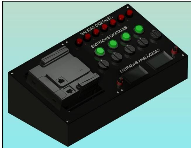
*Ilustración 18: Diseño en AutoCAD® de la distribución de elementos*
