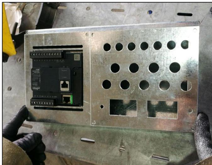
Ilustración 16. Estructura metálica corte y construcción con plancha galvanizada
