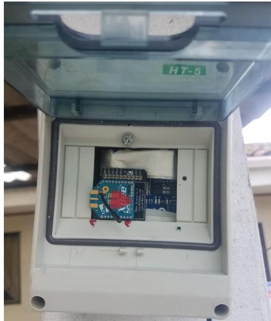
*Figura 2.27. Módulo de estación de recepción de datos.*
