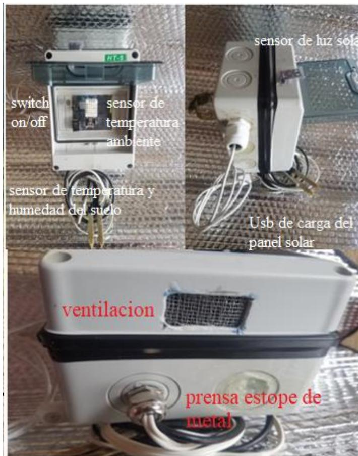
Figura 2.26. Modelo 2 del Módulo del Nodo Router 1 y 2
