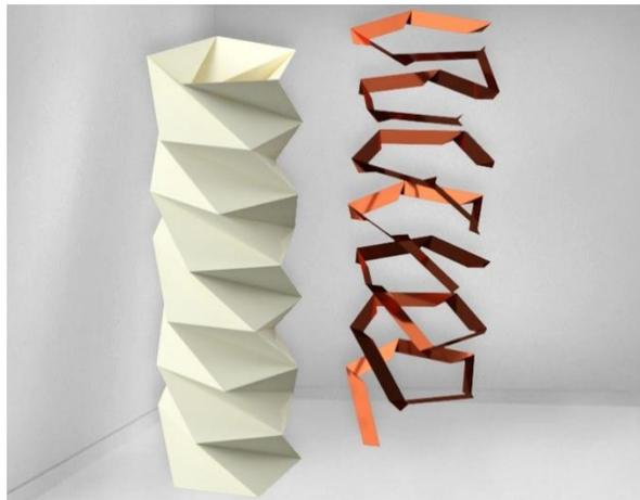
**Figura 37.** Renderizado del dibujo de la estructura de la antena en 3D y de la cinta de cobre que la envuelve
