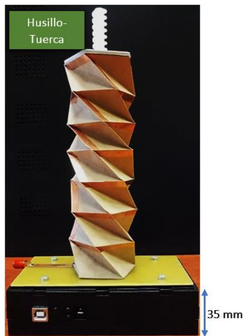
**Figura 91.** Antena origami acoplada al mecanismo.
