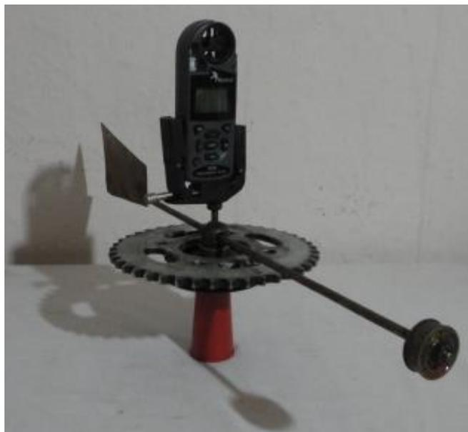
Fotografía 5 y Fotografía 6 Anemómetro con base de direccionamiento
