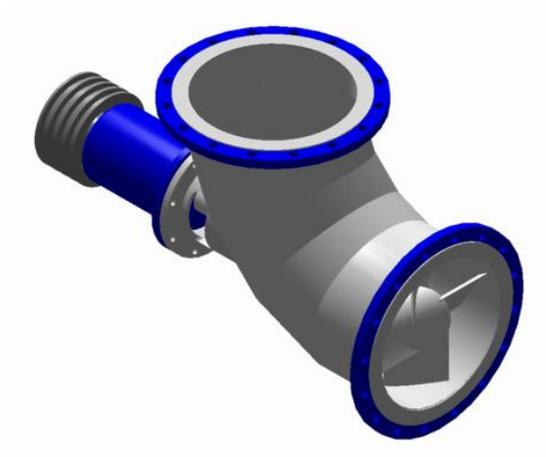
Figura 8 Bomba rotodinámica axial
