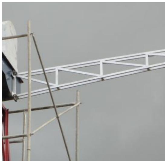
Fotografía 16 Sistema articulado en la sujeción sistema de orientación - caja reductora
