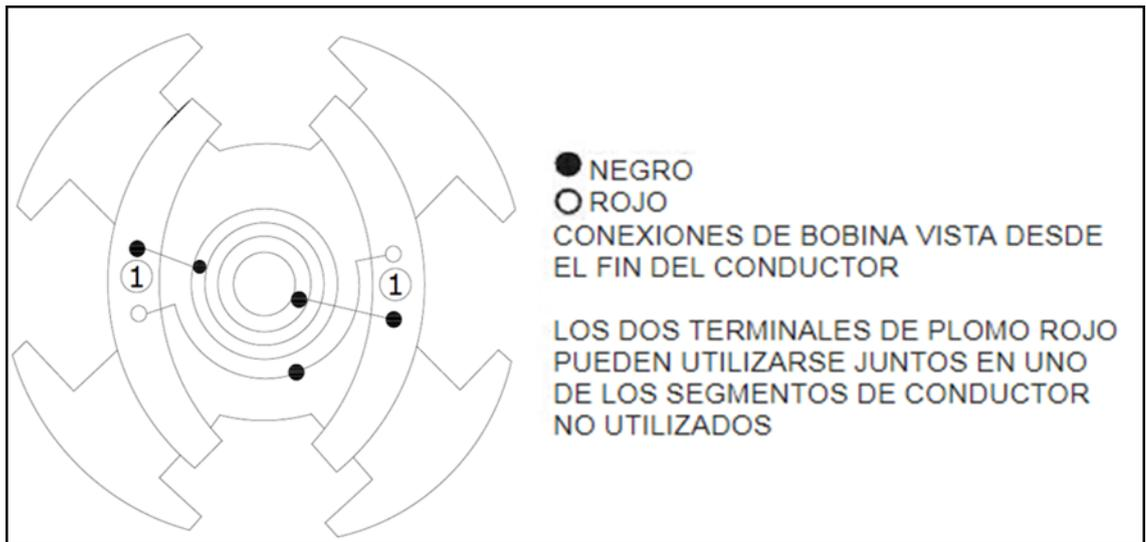
FIGURA 68: DIAGRAMA DE CABLEADO DEL ROTOR
