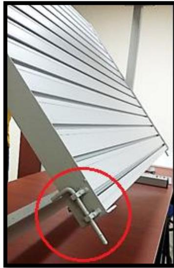
FIGURA 57: PICAPORTE PARA FIJACIÓN EN EL MÓDULO.
