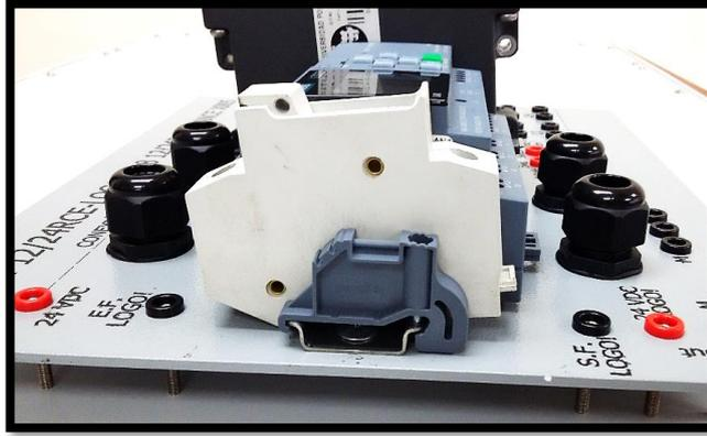
FIGURA 68: FIJACIÓN DE LOS EQUIPOS EN RIEL DIN.
