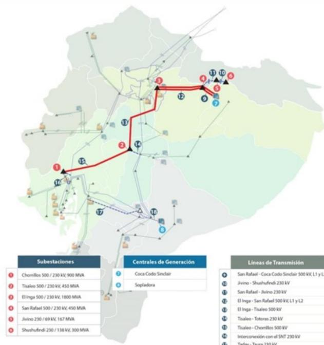
FIGURA 32. SISTEMA DE TRANSMISIÓN DE 500 KV. ECUADOR
