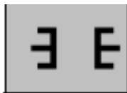
Figura 2.14. Contacto normalmente abierto
