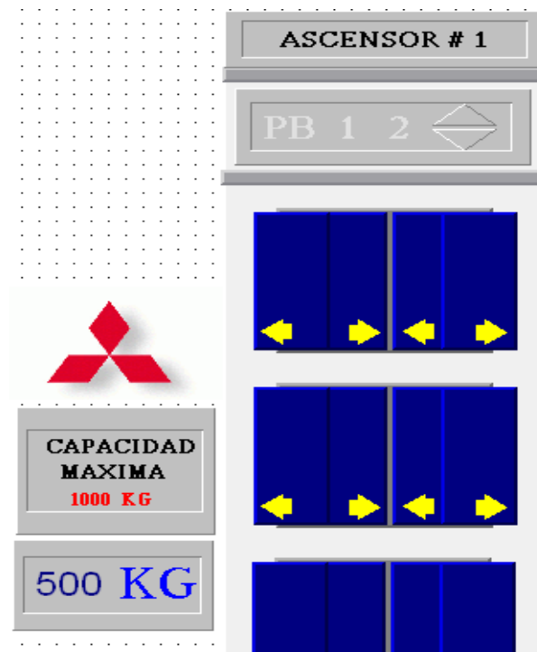
Figura 4.58 Monitoreo del Peso Ascensor #1 Fuente: Autores 2011
