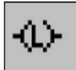
Figura 2.19. Bobina de enclavamiento de salida
