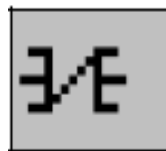
Figura 2.16. Contacto normalmente cerrado
