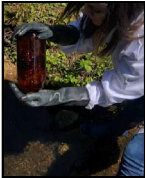
*Fotografía 6 Toma de muestra para el análisis microbiológico del agua*
