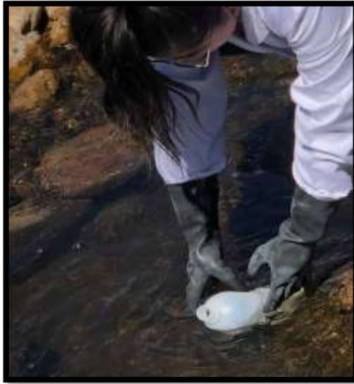
*Fotografía 5 Toma de muestra para el análisis físico del agua*
