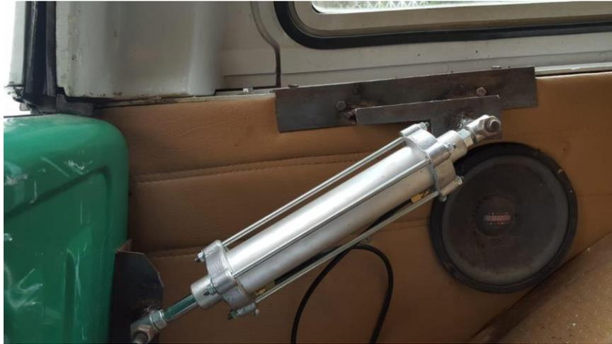
Figura #43 - Cilindro neumático para control de puertas
