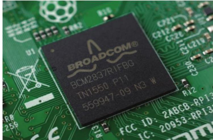
Figura #3 - SOC Broadcom de una Raspberry PI (Raspberrypi, 2014)
