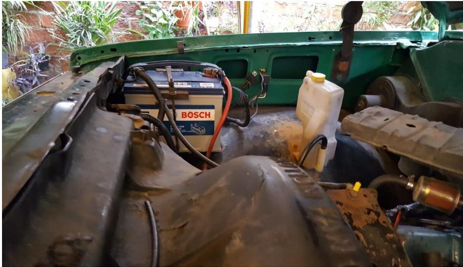
Figura #48 - Alimentación del sistema desde la batería del carro
