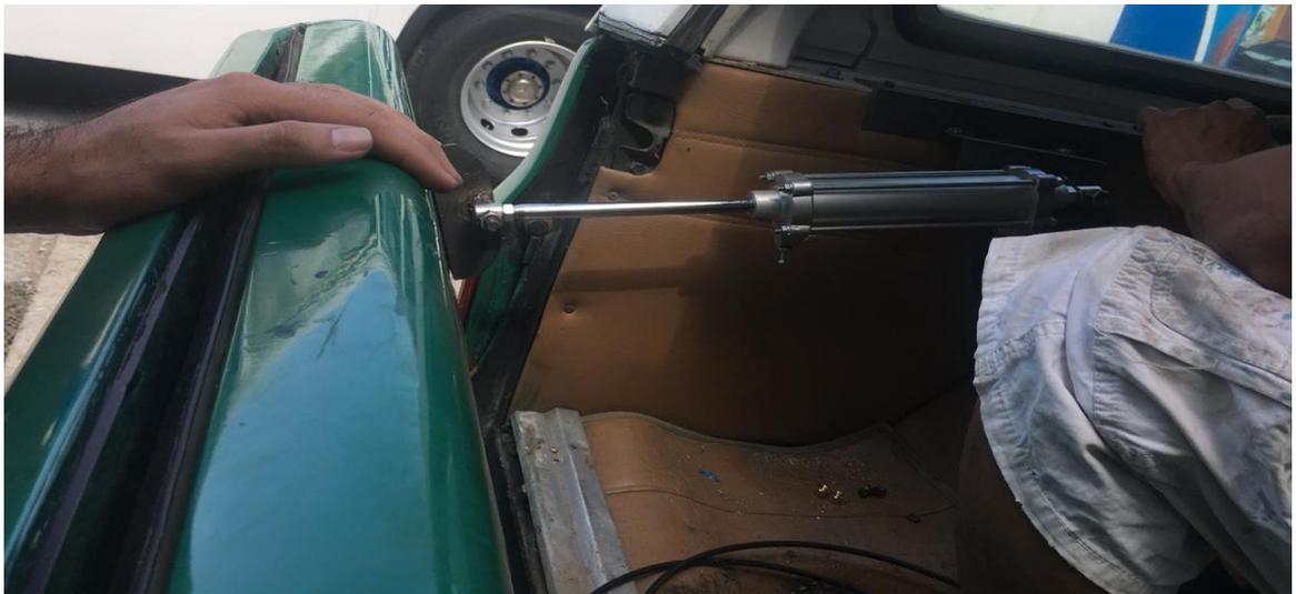
Figura #49 - Control de apertura de la puerta con cilindro neumático.
