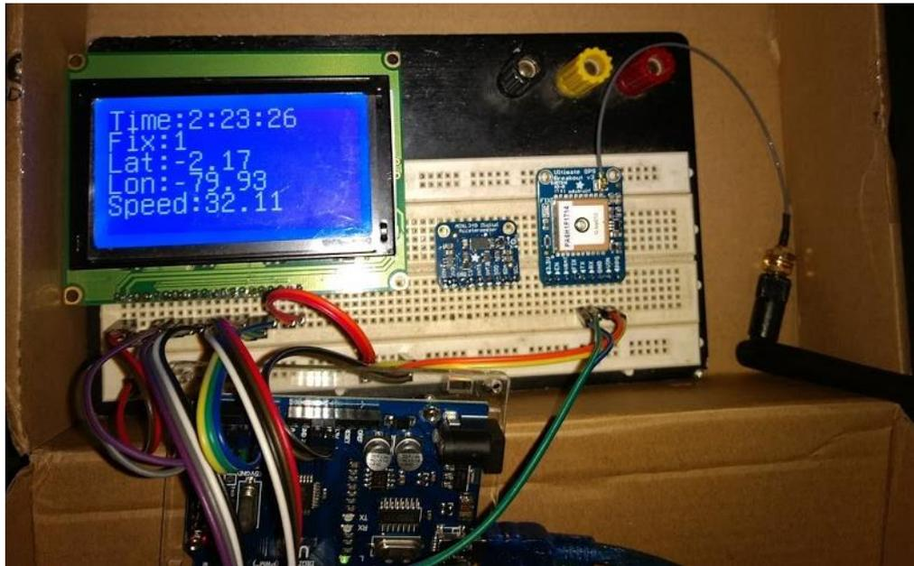
Figura #21 - Pruebas de funcionamiento del GPS en prototipo
