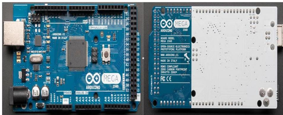
Figura #7 - Placa de arduino con cada una de las especificaciones del Arduino Mega 2560 (UGE-ONE, 2016)
