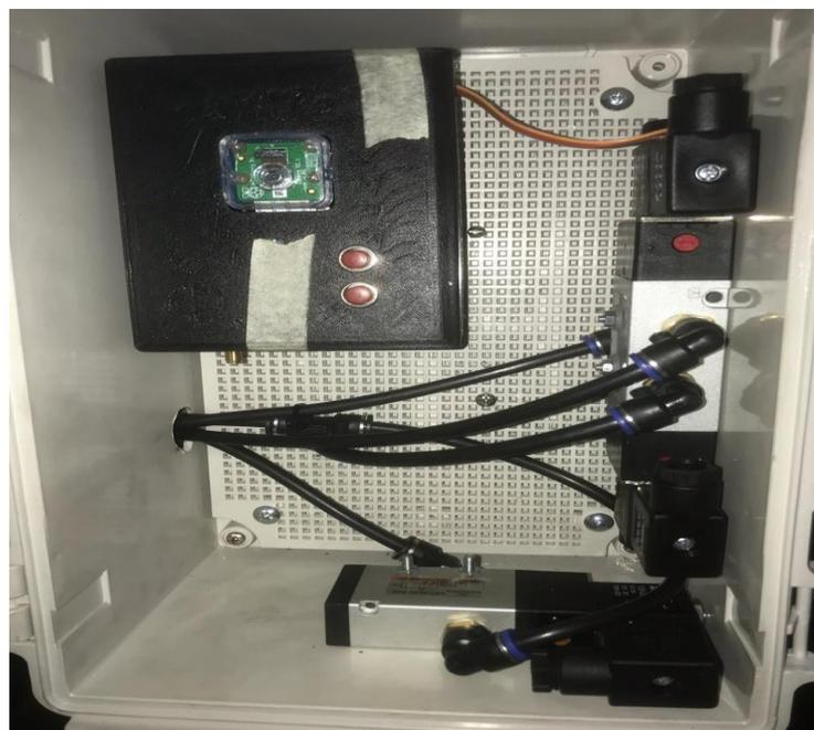
Figura #47 - Instalación de la Electro-válvula
