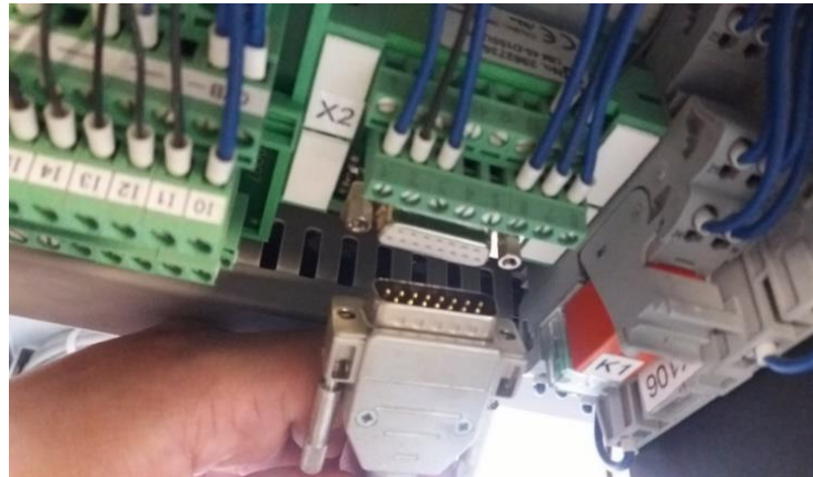
Figura 10: Visualización de los pines de salida de la tarjeta Easy Port de la planta de Festo.
