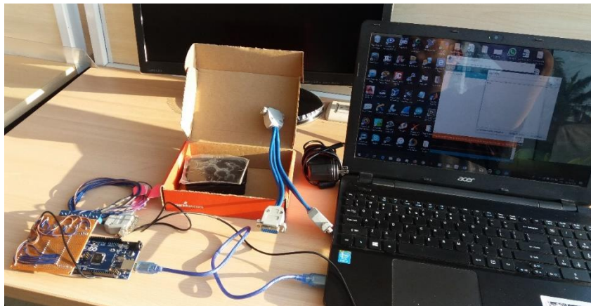
Figura 14: Comunicación entre las tarjetas Arduino y Raspberry Pi.
