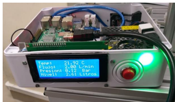
Figura 28. Led indicador que el módulo GSM se encuentra activo.
