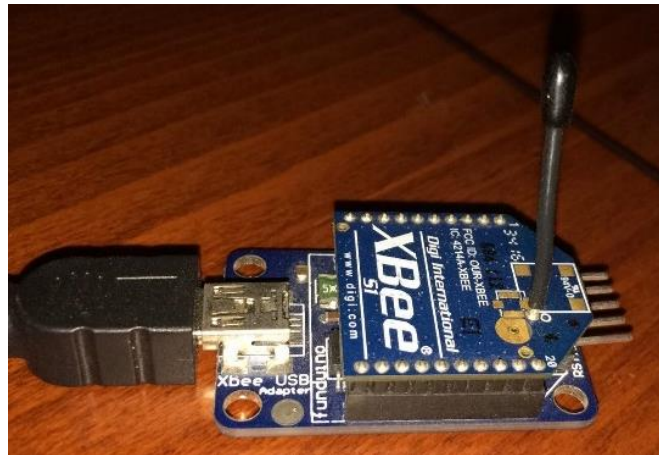
Figura 89: Adaptador UART XBee
