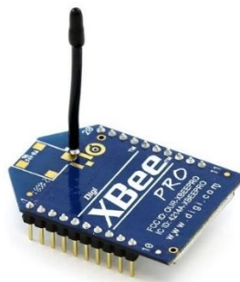
Figura 21:Modulo Xbee (Morillo, 2017)
