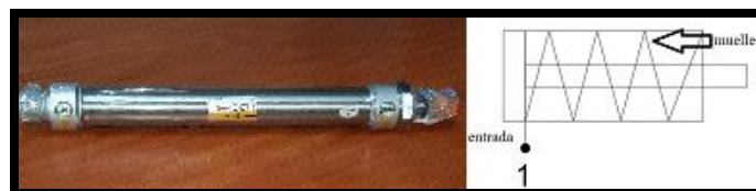
Figura 35. Cilindro de simple efecto y simbología.
