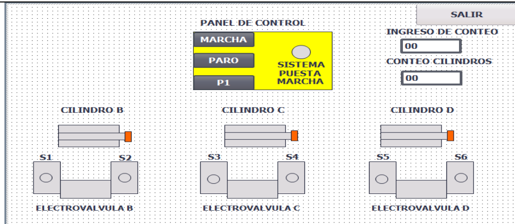
Figura 131. Diseño de pantalla HMI Practica #5 en el software TIA Portal.
