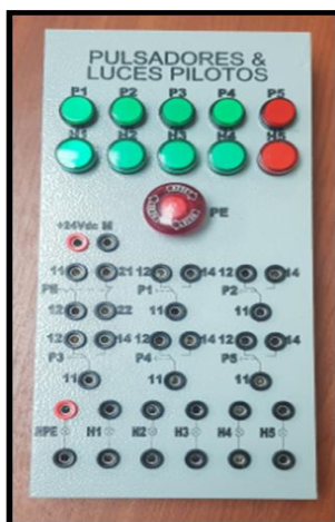
Figura 50. Lámina de pulsadores y luces piloto.
