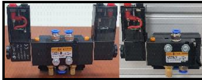
Figura 56. Montaje de electroválvula 5/2 biestable y electroválvula 3/2 monoestable
