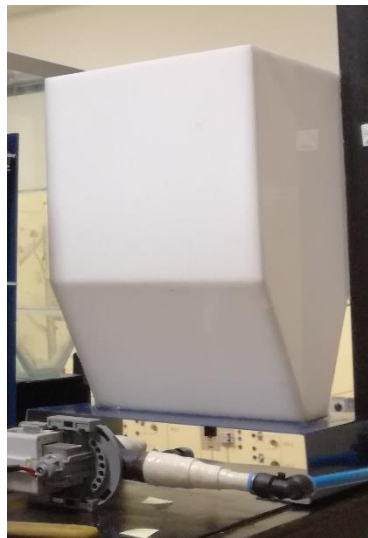
Fig. 16 Tanque de abastecimiento
