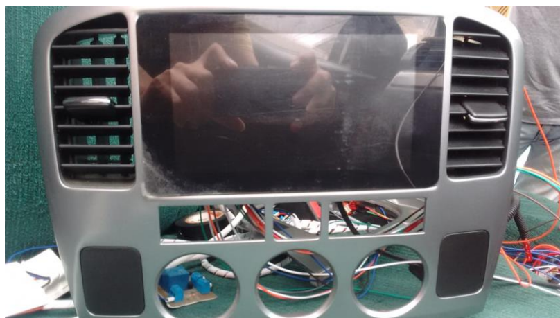
Figura 84. Instalación de pantalla LCD 7" en el panel frontal del carro
