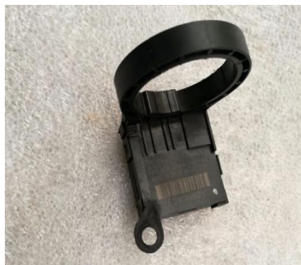
Figura 26. Antena de un sistema transponder
