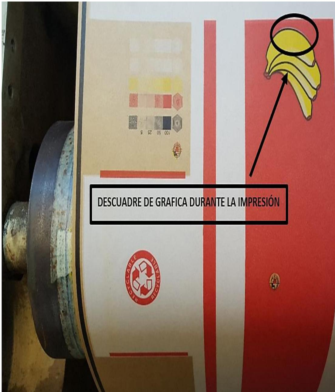
Figura 3.6 Descuadre del gráfico durante el proceso de impresión
