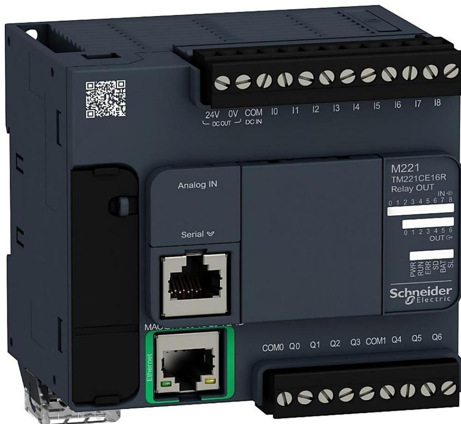
Figura 2.5 Controlador Lógico Programable PLC SCHNEIDER EcoStruxure Modicon M221-TM221CE16R
