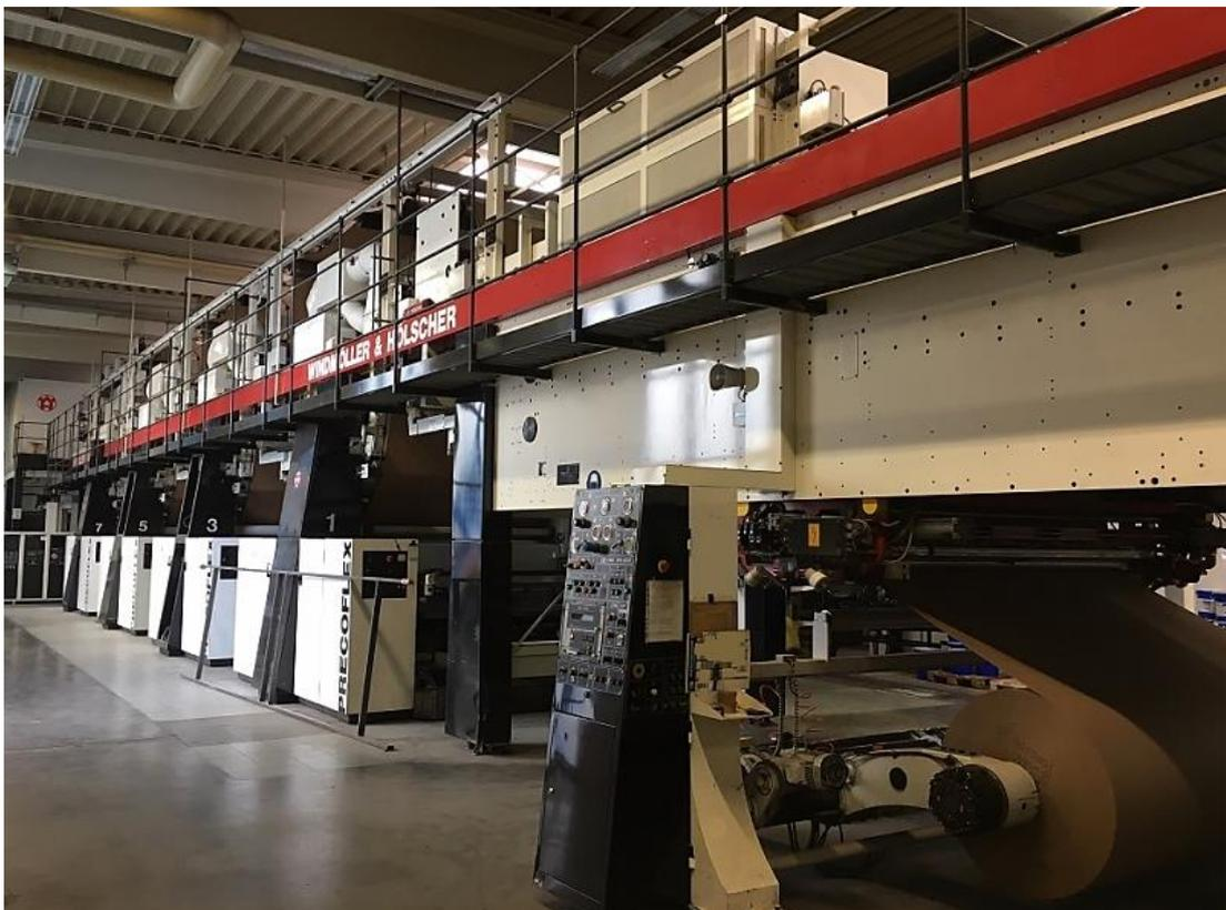
Figura 1.3 Máquina preimpresión flexo WINDMÖLLER & HÖLSCHER de 8 colores modelo Precoflex
